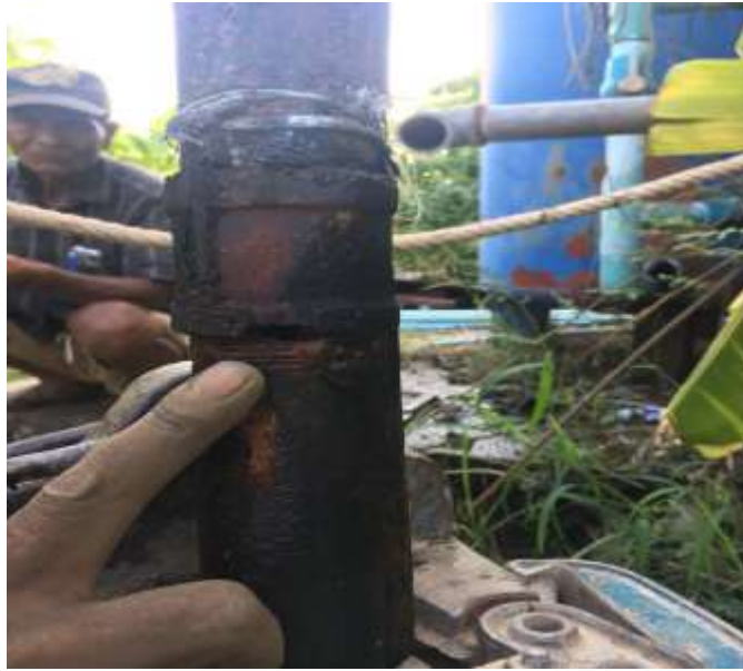
รูปที่ 11 ท่อทะเลเป็นสนิมเกิดจากการกัดกร่อน
