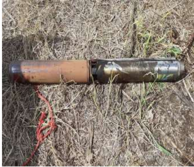
รูปที่ 5 ป้อน้ำบาดาลที่เสียไม่ทำงาน
