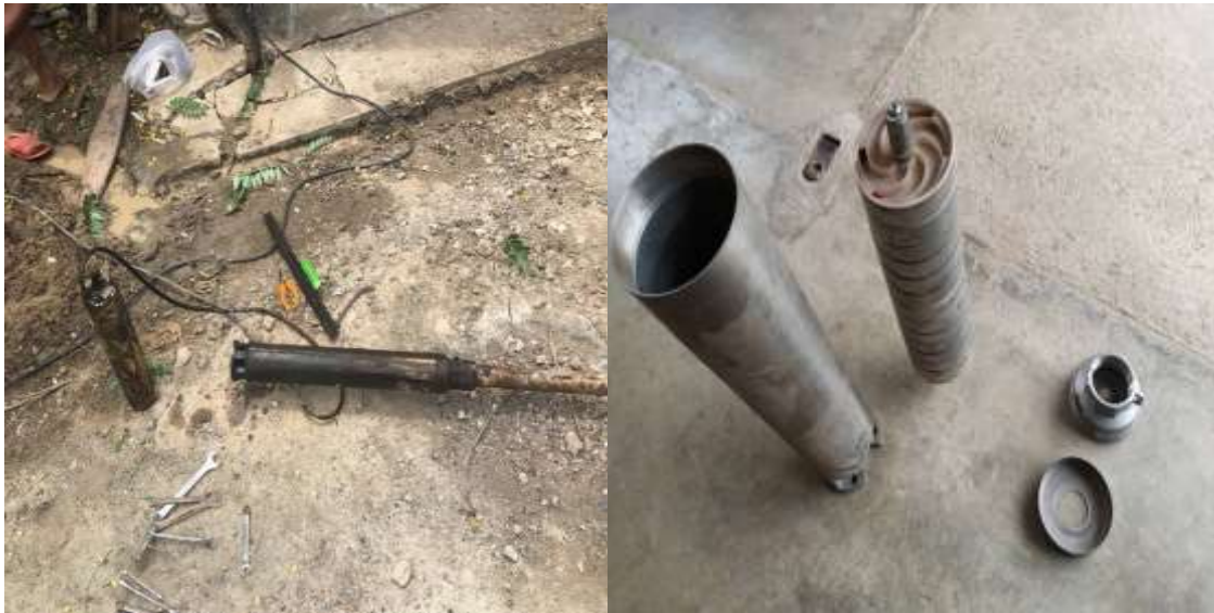
รูปที่ 4.6 ปั้มน้ำบาดาลและใบพัดที่เสียหายจากการที่ทรายเข้าไป
