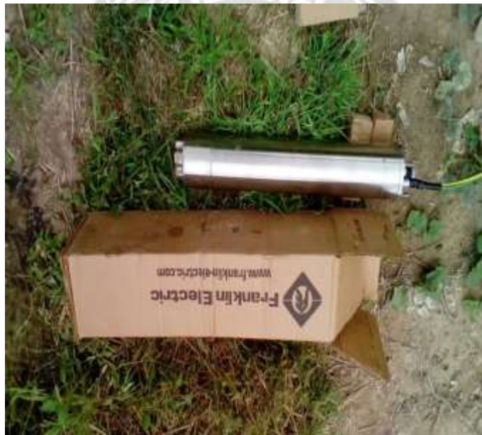
รูปที่ 6 ป้อน้ำบาดาลที่เปลี่ยนใหม่แทนอันที่เสียไม่ทำงาน
