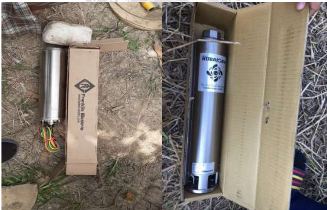
รูปที่ 4.7 เปลี่ยนปั้มน้ำบาดาลและใบพัดเมื่อเกิดความเสียหาย
