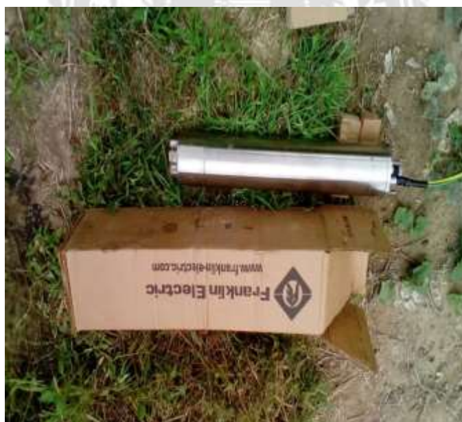
รูปที่ 2.1 ป้อน้ำบาดาล(ปั๊มซัมเมอร์ส)
