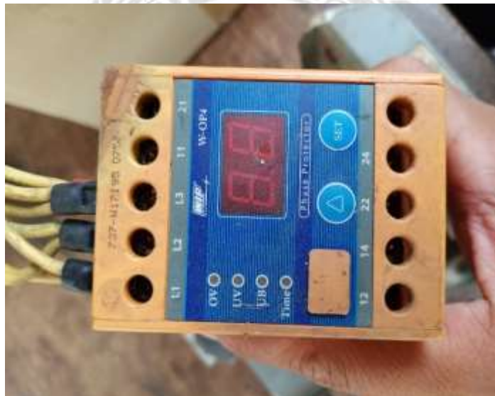
รูปที่ 8 อุปกรณ์ที่ไม่ทำงานเนื่องจากมีมิดเข้าไปจำนวนมาก
