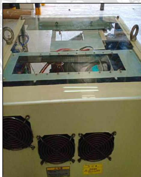
รูปที่ 4.10 แก้ไขฝาปิดเป็นอะคริลิกใส
