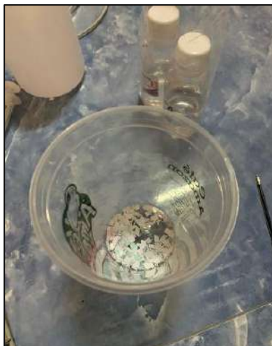
รูปที่ 4.6 ใส่กระดาษที่เตรียมไว้ลงไปบนเรซินที่ผสมไว้ ที่มา : ผู้จัดทำ (2563)
