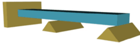
รูปที่ 2.13 คานปลายยื่นแต่มีจุดรับที่ปลาย 2 จุด (Restrained Beam)
