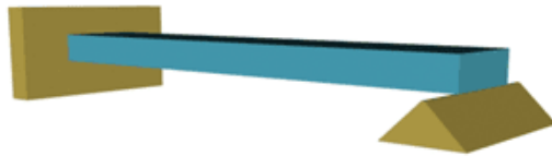
รูปที่ 2.12 คานปลายยื่นแต่มีจุดรับที่ปลายยื่น (Simply Supported Beam)
