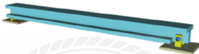
รูปที่ 2.9 คานที่จุดรองรับแบบง่าย (Simple Supported)
