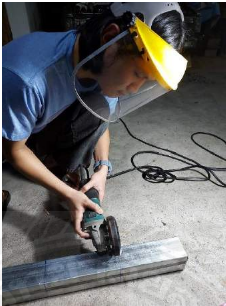
รูปที่ 3.22 การตัดชิ้นงาน
