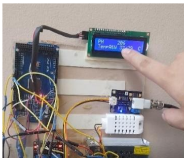
รูปที่ 10 การทดสอบการอ่านค่าอุณหภูมิสภาพอากาศ
