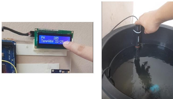
รูปที่ 9 การทดสอบการอ่านค่าความเป็นกรดต่าง
