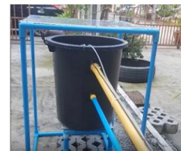
รูปที่ 7 การทดสอบการอ่านค่าอุณหภูมิของน้ำเค็ม
