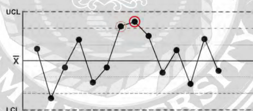
รูปที่ 2.6 กฎข้อที่ 5 มี 2 หรือ 3 จุดจาก 3 จุดต่อเนื่องกันที่อยู่ห่างจากค่าเฉลี่ยมากกว่า +2\sigma หรือน้อยกว่า -2\sigma
