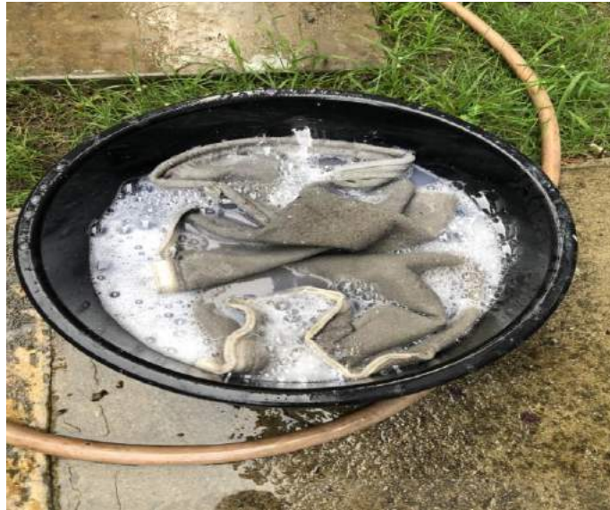
รูปที่ 3.28 ถุงผ้ากรองสระว่ายน้ำนำมาแช่น้ำยาล้าง
