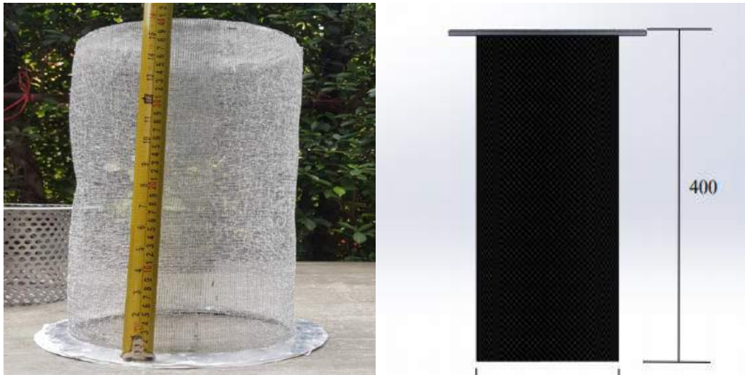
รูปที่ 3.11 แบบและอุปกรณ์จริงด้านหน้าของกรองน้ำระวายน้ำชั้นที่ 2
