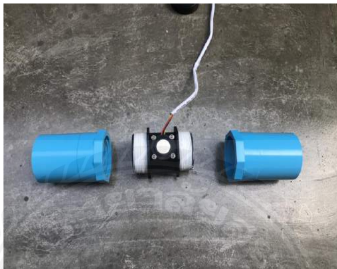
รูปที่ 3.20 สวิทซ์การไหลและข้อต่อท่อ PVC ขนาด 2 นิ้ว
