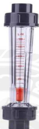
รูปที่ 2.9 เซนเซอร์วัดอัตราการไหลแบบชนิดเข็ม
