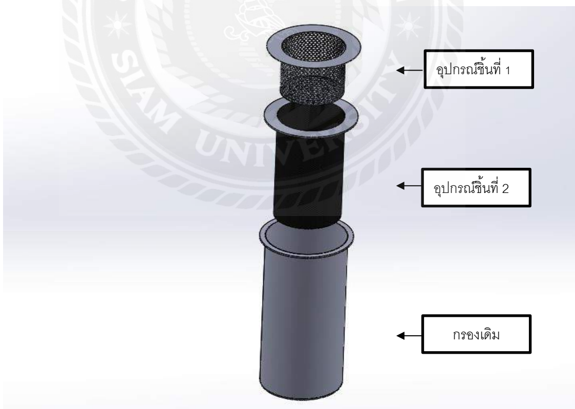
รูปที่ 3.6 แบบกรองน้ำสระว่ายน้ำแบบสก็มเมอร์
