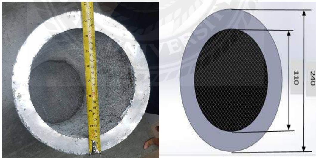
รูปที่ 3.10 แบบและอุปกรณ์จริงด้านบนของกรองน้ำระวายน้ำขึ้นที่ 2
