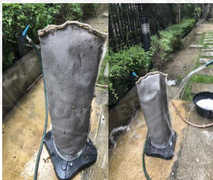
รูปที่ 3.27 วิธีล้างกรองสละว่น้ำสกินเมอร์
