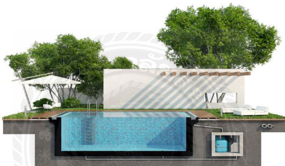
รูปที่ 2.5 ภาพแบบระบายน้ำระบบน้ำล้น
