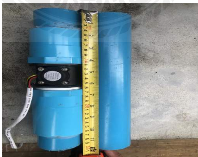
รูปที่ 3.21 สวิทซ์การไหลแบบใบพัด ที่ติดตั้งกลับตัวต่อตรงท่อ PVC ขนาด 2 นิ้ว
