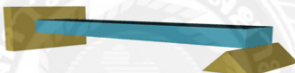
รูปที่ 2.18 คานปลายยื่นแต่มีจุดรับที่ปลายยื่น (Restrained Beam)
