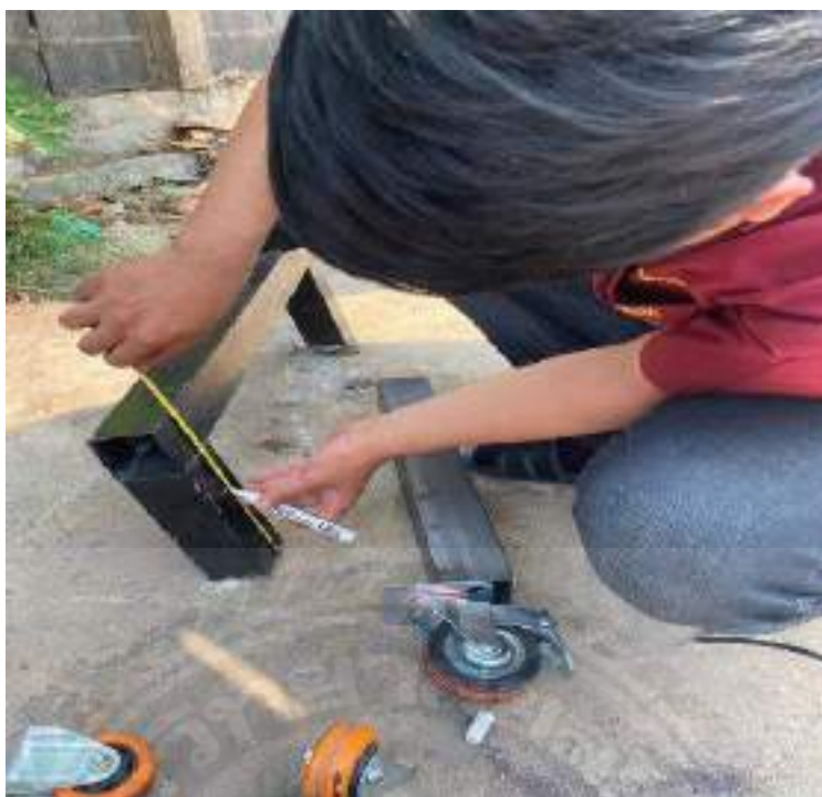
รูปที่ 3.45 ทำการวัดตำแหน่งเพื่อเจาะรู
