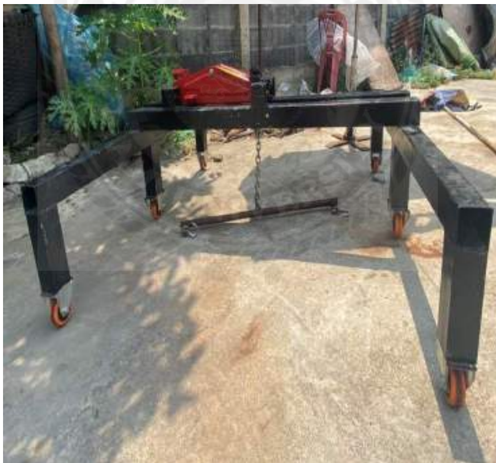
รูปที่ 3.3 เครื่องเปิดและปิดฝาบ่อบำบัดน้ำเสียก่อนทำการปรับปรุง
