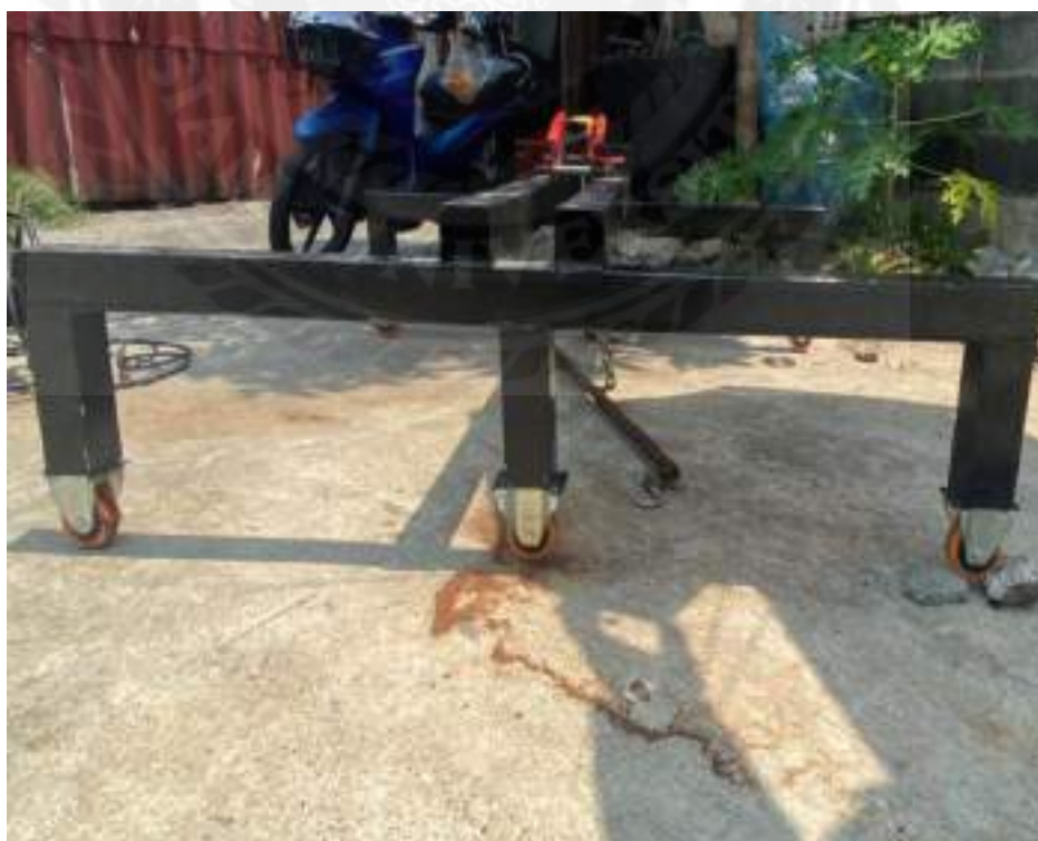
รูปที่ 3.5 ล้อยางแบบหมุนไม่ได้ และล้อคเบรกไม่ได้
