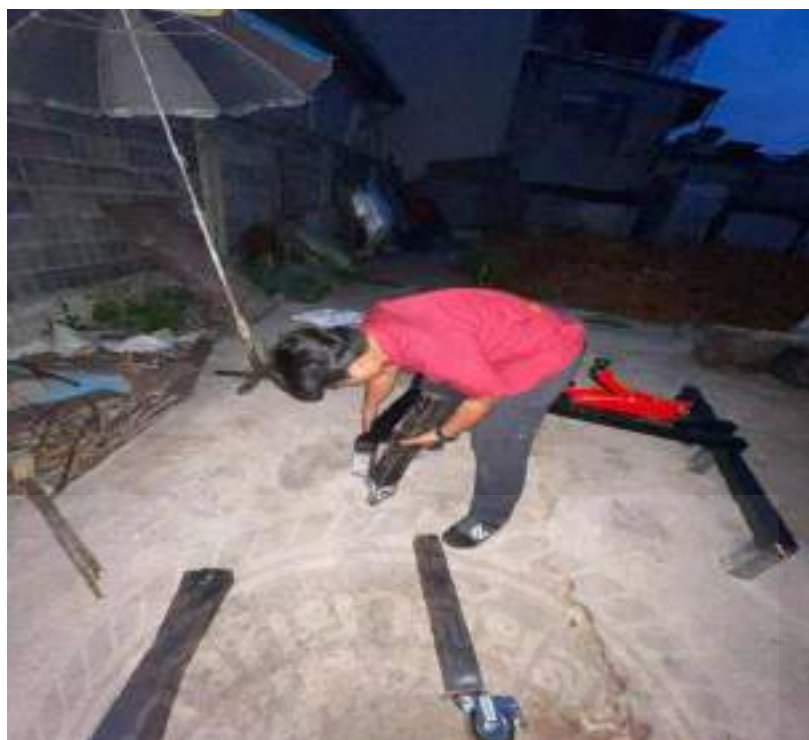
รูปที่ 3.51 การประกอบเหล็กกล่องเข้ากับโครงชิ้นงาน
