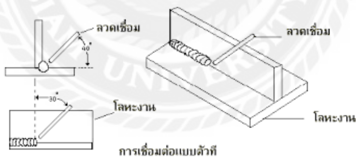
รูปที่ 2.34 การเชื่อมต่อแบบตัวที
