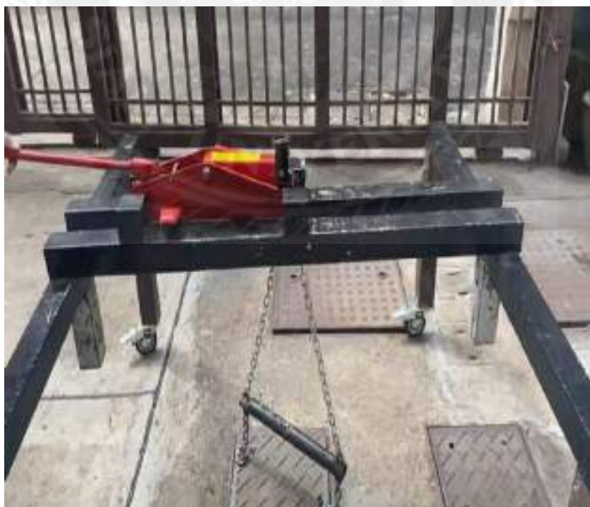
รูปที่ 3.52 การติดตั้งอุปกรณ์ยกฝาท่อเข้ากับชิ้นงาน
