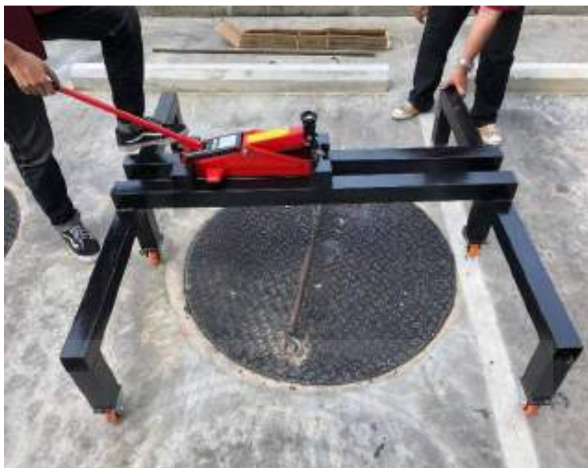
รูปที่ 4.3 ต้องใช้มือจับและเท้ายันไว้เพื่อความมั่นคงขณะใช้งาน
