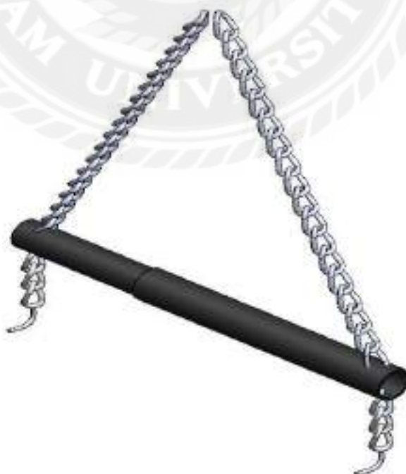
รูปที่ 3.7 การออกแบบอุปกรณ์เกี่ยวฝาท่อที่ปรับระยะได้
