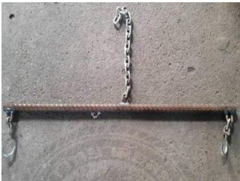
รูปที่ 3.4 อุปกรณ์ส่วนที่ยกฝาบ่อบำบัดน้ำเสียแบบตายตัว
