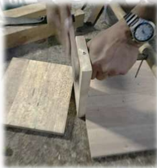
รูปที่ 4.23 ใช้กระดาดทรายเก็บรายละเอียดให้เรียบร้อย ที่มา : ผู้จัดทำ (2564)
