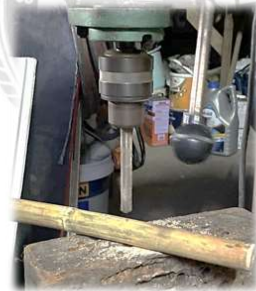
รูปที่ 4.15 วัดขนาดไม้ไผ่ D และเจาะรูขนาด 15 เซนติเมตร ตรงกลางไม้ไผ่ ที่มา : ผู้จัดทำ (2564)
