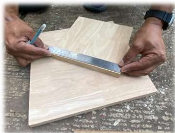
รูปที่ 4.6 วัดขนาดของไม้แผ่นยางพารา B เพื่อตัดแบ่งเป็น 2 ส่วน ให้ได้ขนาดแผ่นละ 10 เซนติเมตร ที่มา : ผู้จัดทำ (2564)
