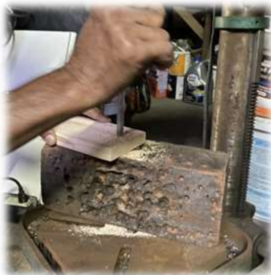
รูปที่ 4.14 วัดขนาดแผ่นไม้ B ทั้งสองแผ่นและเจาะรูขนาด 15 เซนติเมตร ตรงกลางแผ่นไม้ ที่มา : ผู้จัดทำ (2564)
