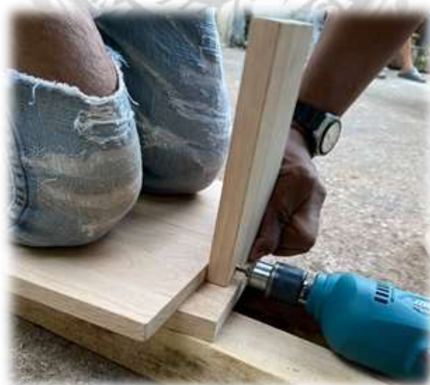
รูปที่ 4.13 เจาะรูแผ่นไม้ A กับ B ตามขนาดที่ได้ทำการวัดไว้ ที่มา : ผู้จัดทำ (2564)
