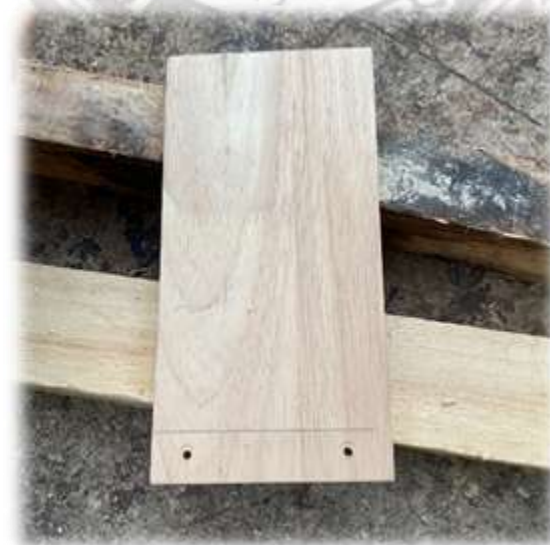
รูปที่ 4.11 ขนาดแผ่นไม้ B ที่เจาะ 2 เซนติเมตร วัดจากค้ำนอกของแผ่นไม้
