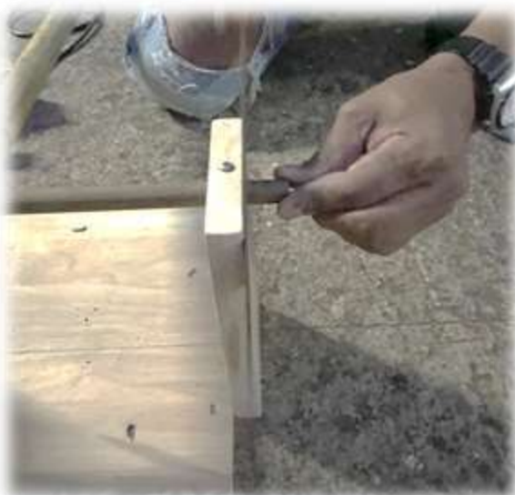
รูปที่ 4.22 ตัดแท่งไม้ C ส่วนเกินออก ที่มา : ผู้จัดทำ (2564)
