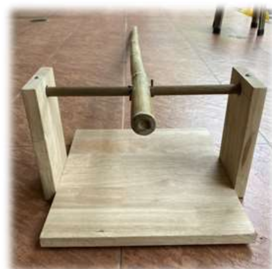
รูปที่ 4.18 นำแท่งไม้ C ใส่ตามรูแผ่นไม้ B ไม้ไผ่ D เพื่อเป็นแกน ที่มา : ผู้จัดทำ (2564)
