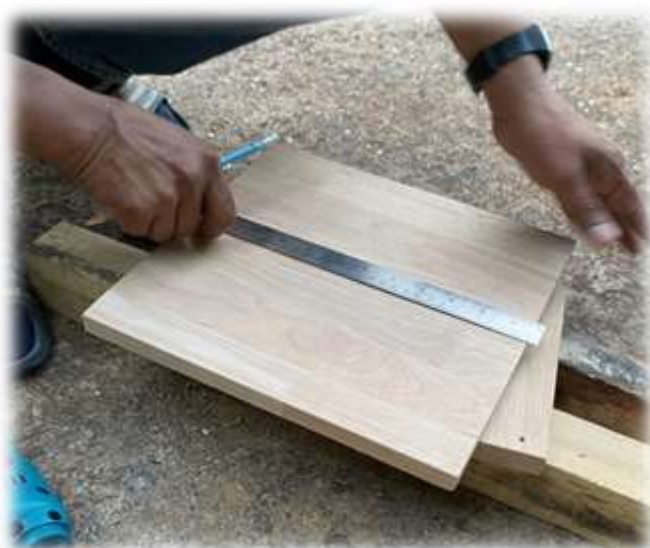
รูปที่ 4.12 วัดขนาดแผ่นไม้ A ให้อยู่ตรงกลาง จะได้ข้างละ 15 เซนติเมตร ที่มา : ผู้จัดทำ (2564)
