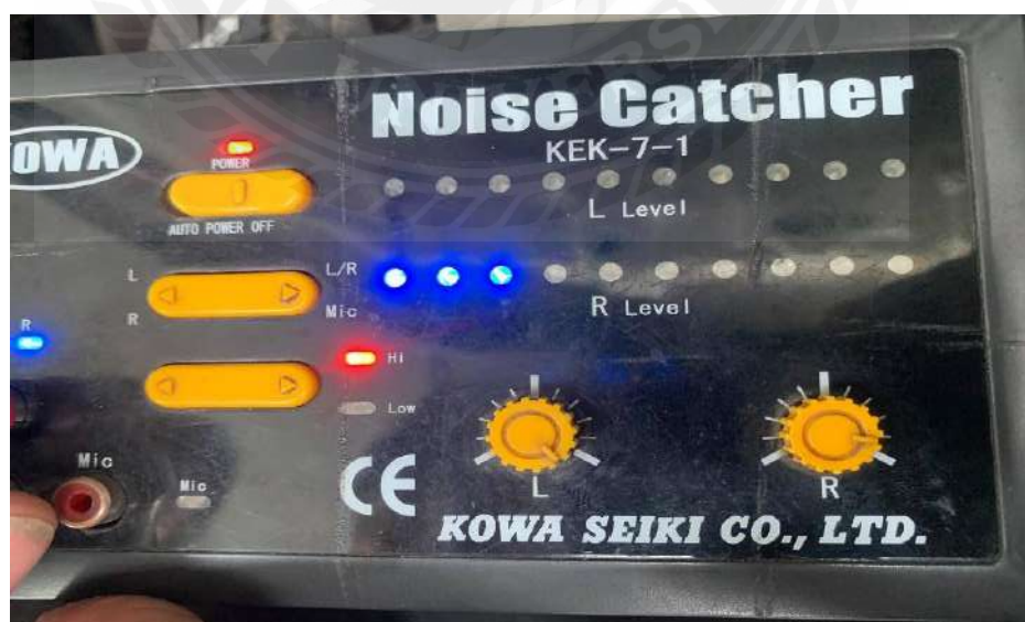
รูปที่ 3.8 ทำการตรวจสอบการหมุนพวงมาลัย ไม่พบเสียงดัง
