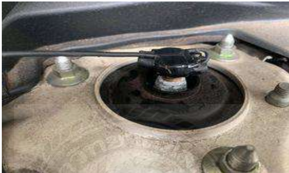
รูปที่ 3.5 การติดตั้งเครื่องวิเคราะห์เสียงผิดปกติส่วนโช๊คอัพข้างขวา
