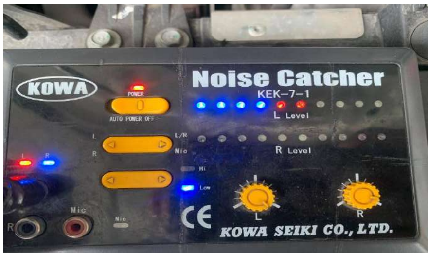
รูปที่ 4.4 การทดสอบปีนกนด้วยเครื่องมือวิเคราะห์เสียงคันที่ 1 พบเสียงผิดปกติระดับดังปานกลาง
