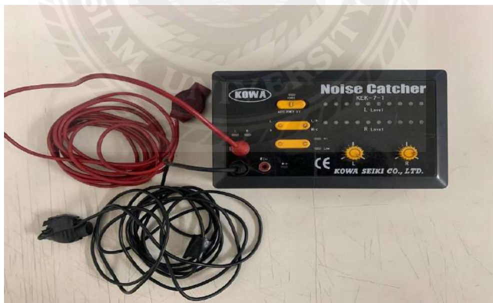
รูปที่ 3.12 การติดตั้งสายเข้ากับตัวเครื่องวิเคราะห์เสียงผิดปกติ
