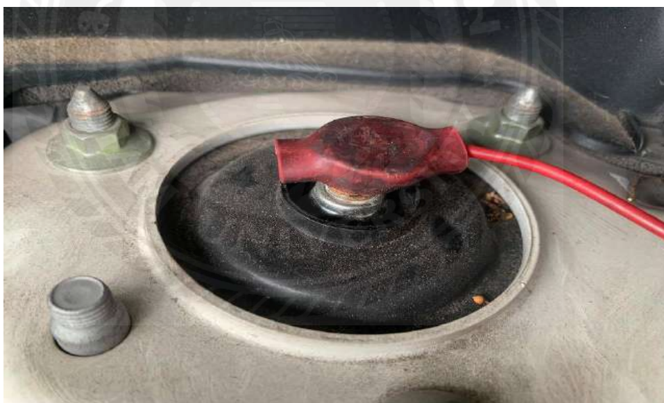
รูปที่ 3.4 การติดตั้งเครื่องวิเคราะห์เสียงผิดปกติส่วนโช้คอัพข้างซ้าย
