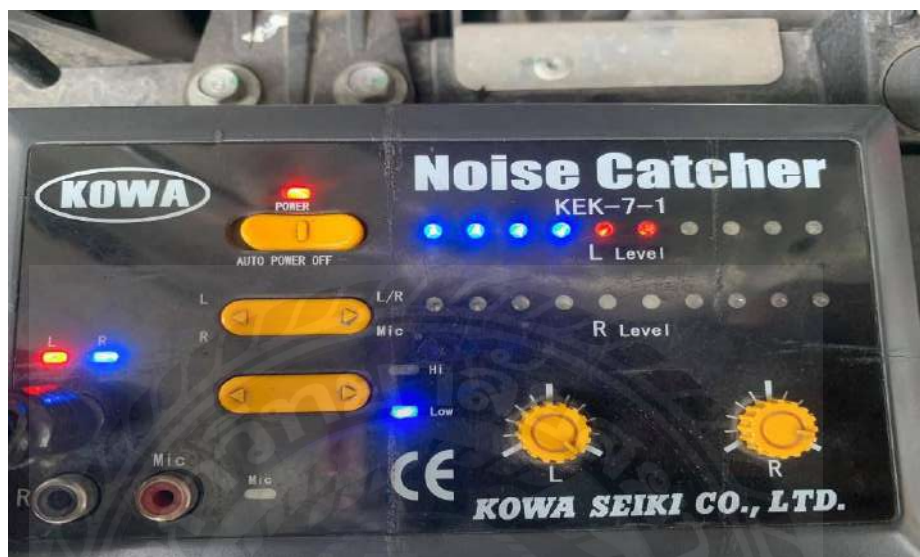
รูปที่ 3.15 ทำการตรวจสอบโดยการวัดทดสอบพบว่ามีเสียงดัง
