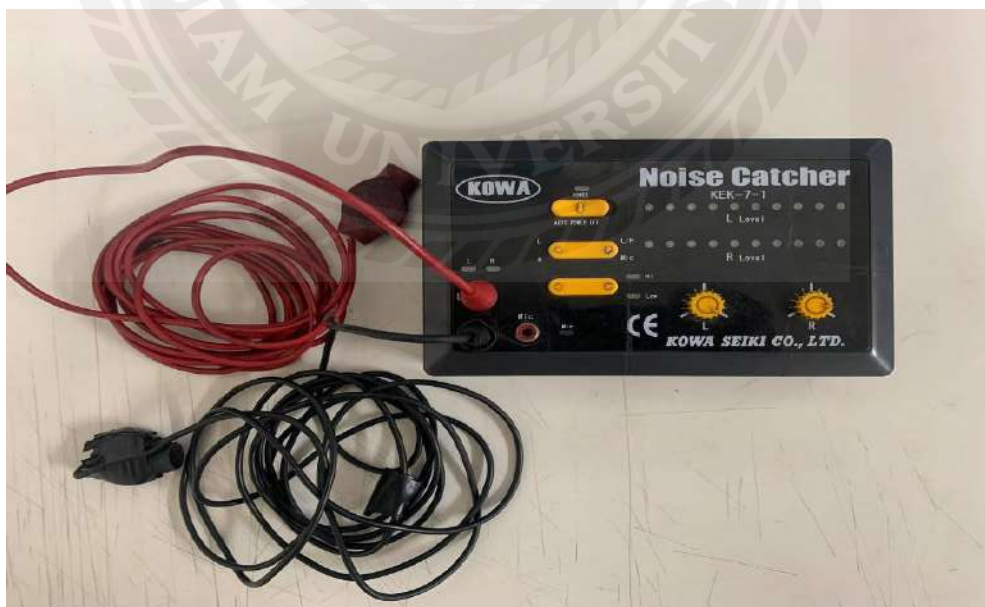
รูปที่ 3.6 การติดตั้งสายเข้ากับตัวเครื่องวิเคราะห์เสียงผิดปกติ
