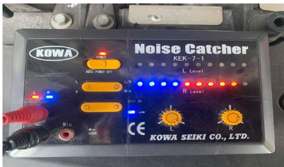
รูปที่ 4.6 การทดสอบปีกนกด้วยเครื่องมือวิเคราะห์เสียงคันที่ 3 พบว่ามีเสียงดังมาก ตารางที่ 4.1.1 การทดสอบแบบไม่ใช้เครื่องมือวิเคราะห์
