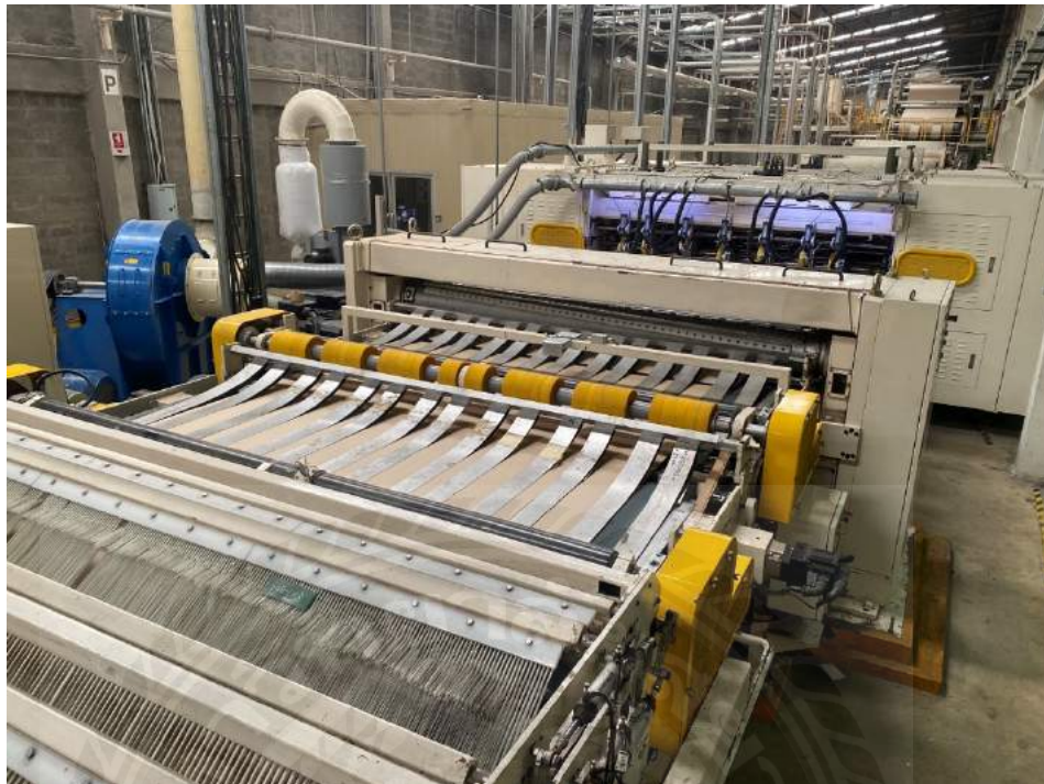
ภาพที่ 2.14 หลังจากผ่านขั้นตอนการทับเส้นแล้ว ก็เข้าสู่กระบวนการตัดความยาวของกระดาษ
