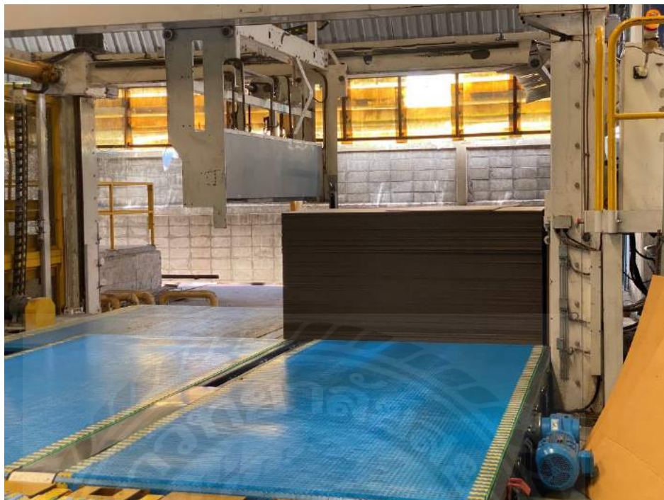
ภาพที่ 2.16 หลังจากที่ทำเส้น และ ตัดความยาวเรียบร้อยแล้วก็จะถูกส่งไปที่เครื่องเรียงกระดาษให้เป็นตั้งเพื่อส่งเข้าเครื่องพิมพ์ต่อไป
