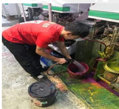
ภาพที่ 2.21 วัดความค่าความหนืดโดยใช้ ZAHN CUP NO.4 ค่าความหนืดอยู่ที่ 6-8 วินาที
