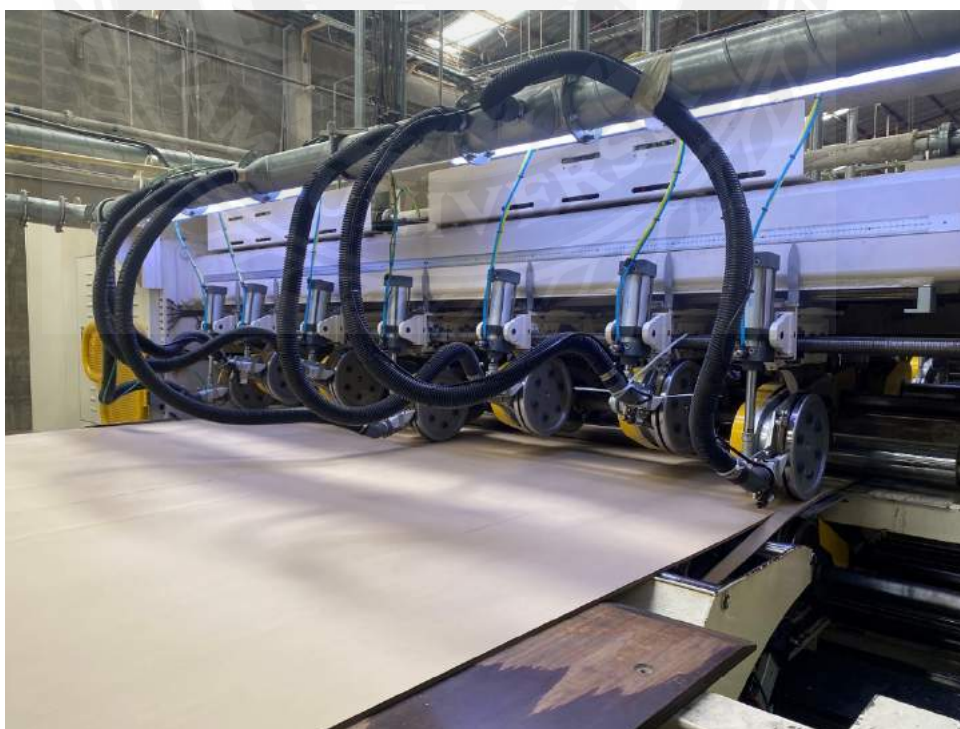
ภาพที่ 2.13 หลังจากผ่านขั้นตอนอบความร้อนแล้วก็เข้าสู่กระบวนการทပ်เส้น
