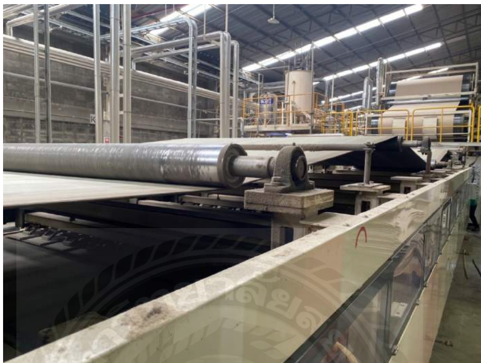
ภาพที่ 2.12 หลังจากนำกระดาษมาประกบกันก็จะนำเข้าเครื่องอบกระดาษโดยใช้ อุณหภูมิ ระหว่าง 170 – 180 องศาเซลเซียส
