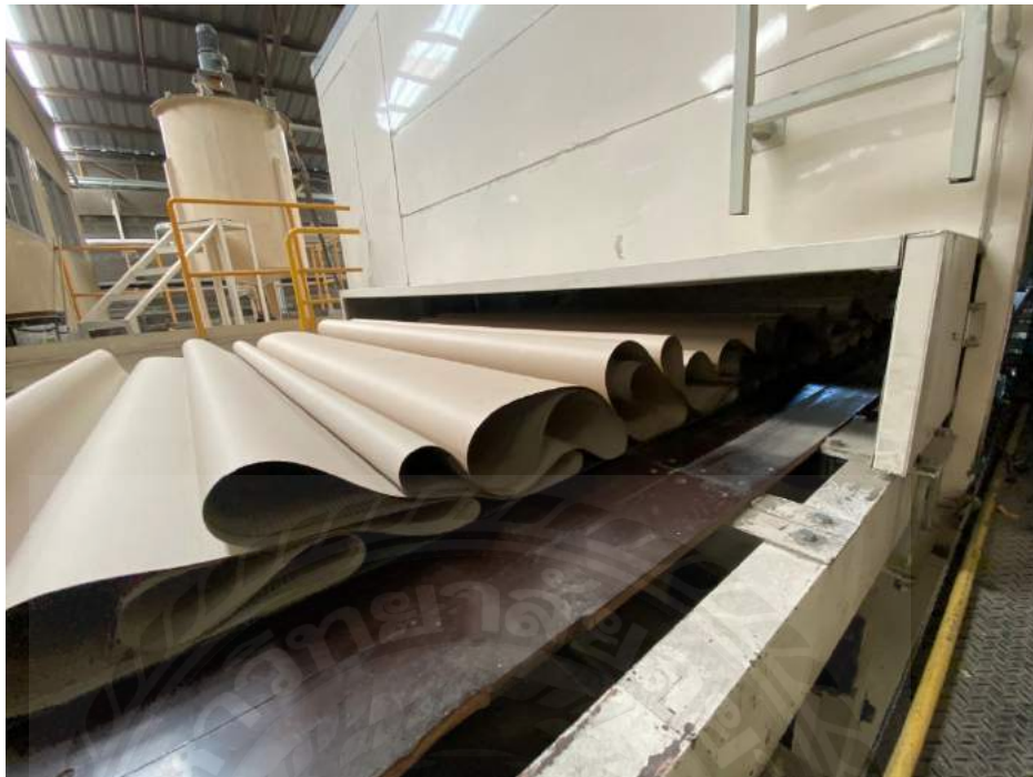
ภาพที่ 2.10 หลังจากผลิตลอนแล้วก็ส่งไปทางสายพานเพื่อไปประกบ กับ กระดาษปะหน้าต่อไป
