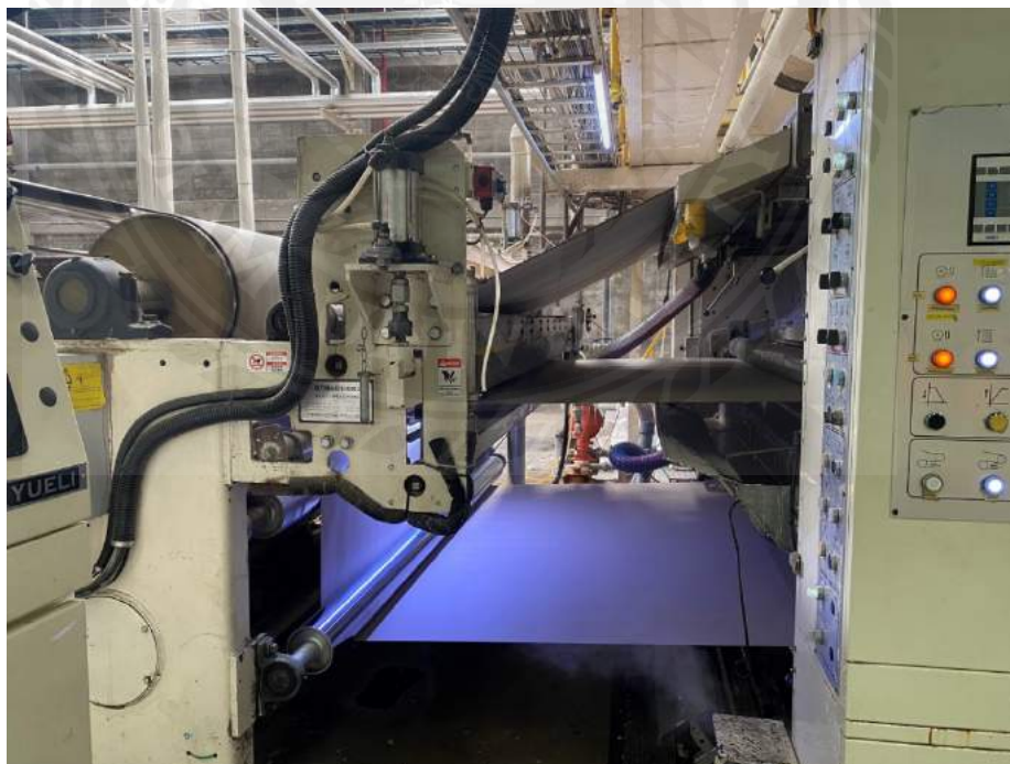
ภาพที่ 2.11 เครื่องประกบกระดาษปะหน้า กับ กระดาษลอน โดยใช้กาวลาเท็กเป็นตัวยึดติดกระดาษ
