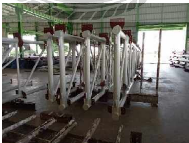
รูปที่ 3.42 แสดงการตรวจสอบสีกันไฟที่โรงงานผลิต (2)
