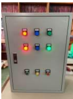
รูปที่ 4.54 ไฟสถานะ K1 , K3 ทำงานเมื่อหน่วงเวลา 5 sec ( PLC ) ( Run Delta )
