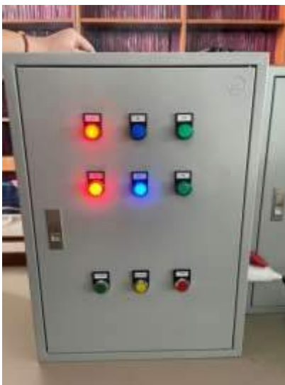
รูปที่ 4.19 ไฟสถานะ K1 , K2 ทำงานเมื่อกด Start ( Run Star )
