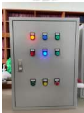
รูปที่ 4.34 ไฟสถานะ K2 ทำงานเมื่อกด Reverses ( PLC )
