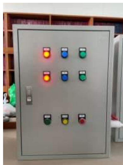
รูปที่ 4.8 ไฟสถานะ K1 ทำงานเมื่อกด Revers
