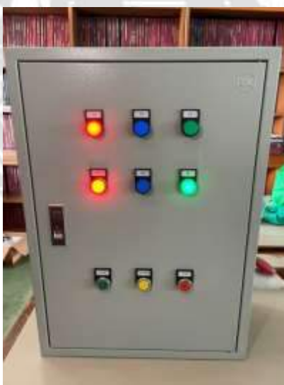
รูปที่ 4.20 ไฟสถานะ K1 , K3 ทำงานเมื่อหน่วงเวลา 5 sec ( Run Delta )
