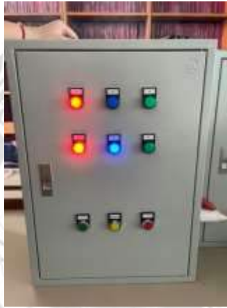
รูปที่ 4.15 ไฟสถานะ K2 ทำงานร่วมกับ K1 หลังจากหน่วงเวลา 5 sec
