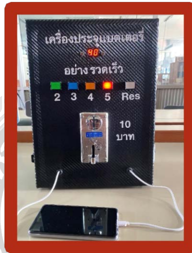
รูปที่ 4.1 เครื่องประจุแบตเตอรี่อย่างรวดเร็วด้วยการหยุดเหรียญควบคุมโดยไมโครคอนโทรลเลอร์
