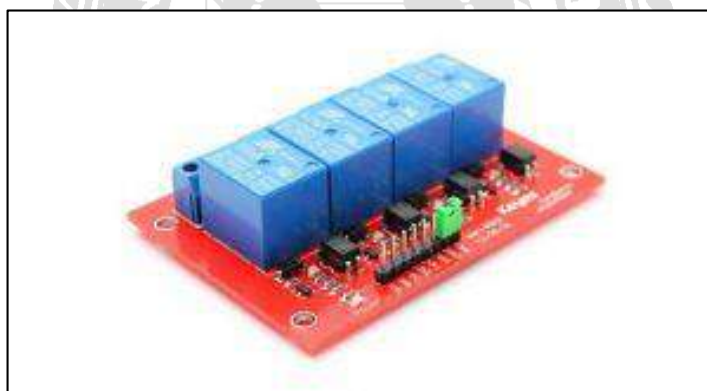
รูปที่ 2.16 ตัวอย่างการใช้งาน Arduino + Relay Module ควบคุมการปิดเปิดเครื่องใช้ไฟฟ้า
