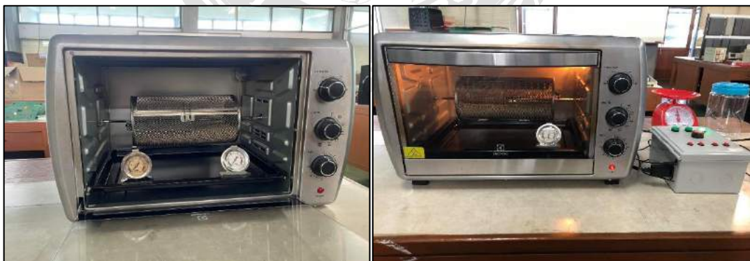
รูปที่ 4.7 ลักษณะของเครื่องคั่วกาแฟแบบอัตโนมัติ
