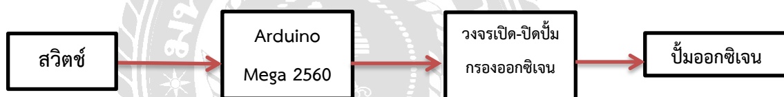
รูปที่ 3.10 บล็อกไดอะแกรมแสดงการทำงานของปั้มน้ำออกซิเจนของตู้ปลา
