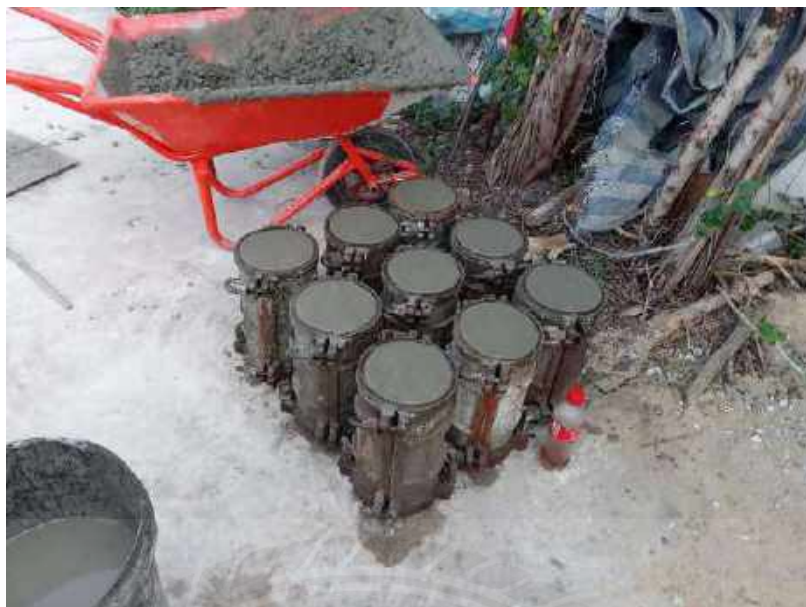
รูปที่ 4-30 เก็บตัวอย่างลูกปูนงานอาคาร ค.ส.ล. 5 ชั้น
