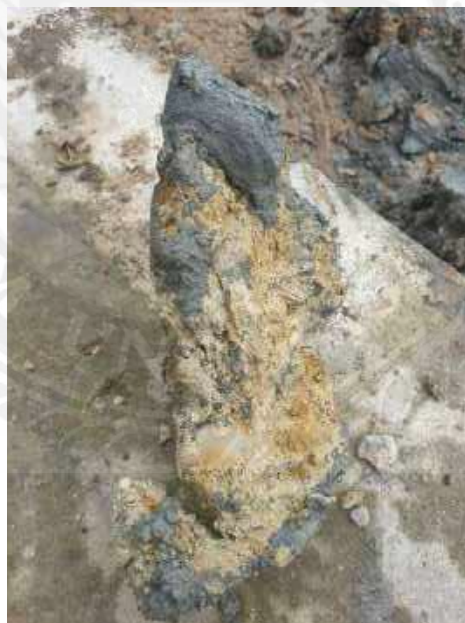
รูปที่ 4-19 สภาพดินความลึกที่ 21.6 เมตร งานอาคาร ค.ส.ล. 5 ชั้น
