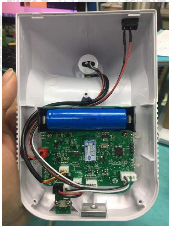
รูปที่ 4.3 รูปวงจรภายในตัวเครื่องวัดอุณหภูมิ
