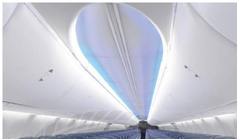
รูปที่ 3.11 ระบบไฟ LED ภายในเครื่องบินโบอิง (BOEING)
