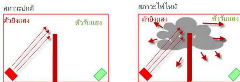
รูปที่ 2.6 อุปกรณ์ตรวจจับควันชนิดโฟโตอิเล็กทริก แบบหักเหแสง (Light Scattering)
