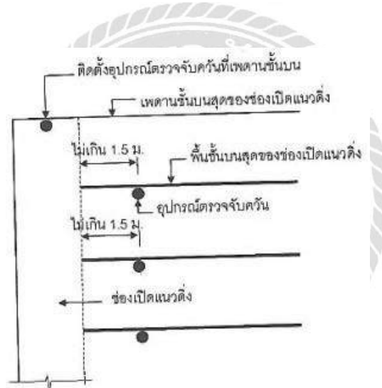
รูปที่ 2.48 การติดตั้งอุปกรณ์ตรวจจับสำหรับช่องเปิดแนวตั้ง
