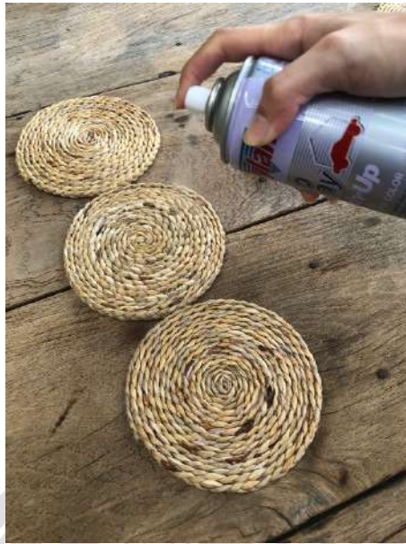
รูปที่ 4.13 การใช้สเปรย์แลคเกอร์พ่นแผ่นรองแก้วจากผักตบชวา
