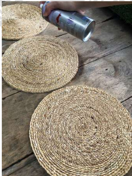
รูปที่ 4.12 การใช้สเปรย์แลคเกอร์พ่นแผ่นรองจานจากผักตบชวา
