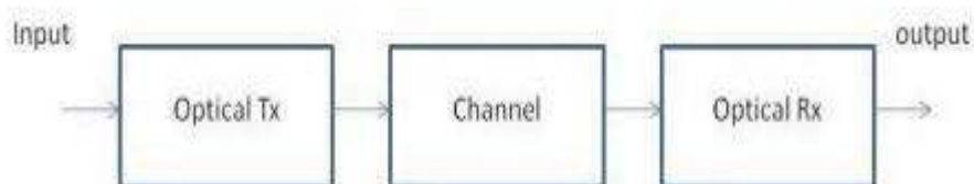
รูปที่ 2.4 การทำงานของ Fiber Optic
