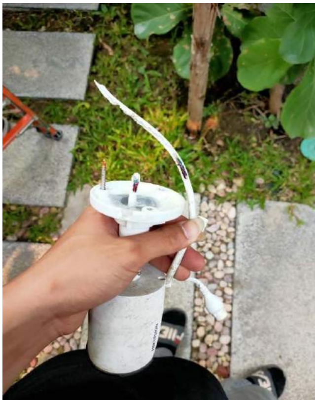
รูปที่ 4.9 สายสัญญาณที่ถูกหนูกัด
