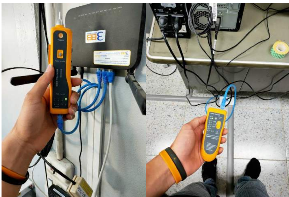
รูปที่ 4.13 การเช็คสายUTP
