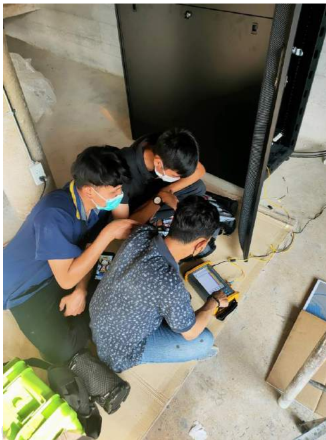
รูปที่ 4.14 Test ด้วยเครื่อง OTDR
