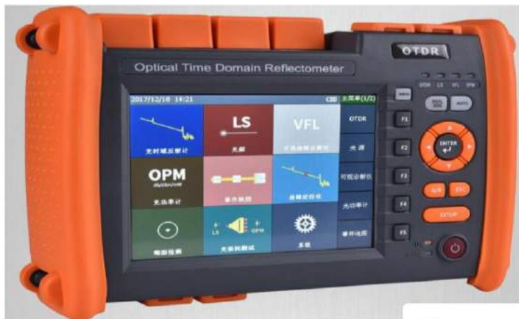
รูปที่ 2.11 เครื่อง OTDR (Optical Time Domain Reflectometer)
