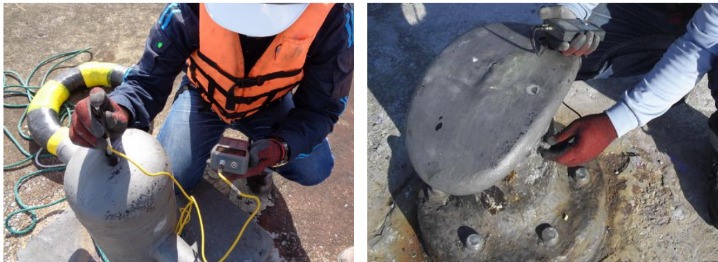
รูปที่ 6 ตรวจสอบกำลังรับแรงดึงเหล็กเสริม F_u ด้วย Hardness Test ตามมาตรฐาน ASTM A 956 [9] และทดสอบความหนาเหล็กโดย Ultrasonic Thickness
