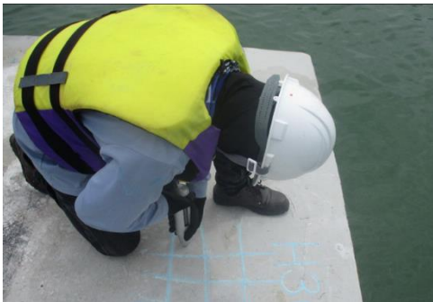
รูปที่ 3 การตรวจสอบด้วย Rebound Hammer ตามมาตรฐาน ASTM C 805 [6]
