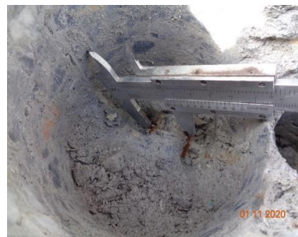
รูปที่ 5 การตรวจสอบหาตำแหน่งเหล็กเสริม โดยวิธี Rebar Scan ตามมาตรฐาน ASTM D6432 [8]
