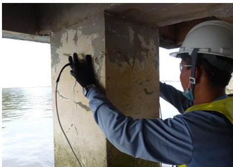
รูปที่ 4 การตรวจสอบด้วย Ultrasonic Pulse Velocity ตามมาตรฐาน ASTM C 597 [7]
