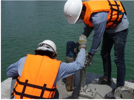
รูปที่ 2 เจาะเก็บตัวอย่างแท่งคอนกรีตด้วยวิธี Coring ตามมาตรฐาน ASTM C 42/C [5] และ ASTM C 39/C
