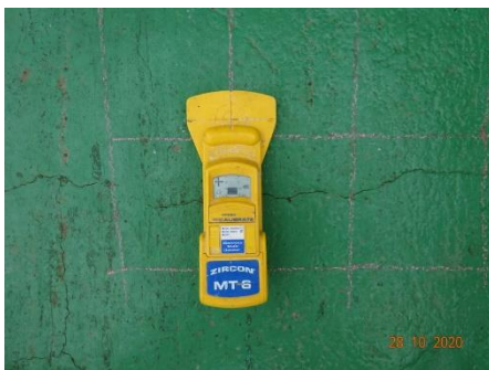
รูปที่ 5 การตรวจสอบหาตำแหน่งเหล็กเสริม โดยวิธี Rebar Scan ตามมาตรฐาน ASTM D6432 [8]
