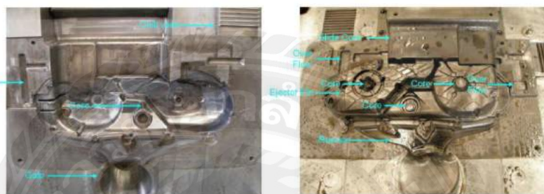
รูปที่ 2.9 แม่พิมพ์ฉีดอะลูมิเนียม
