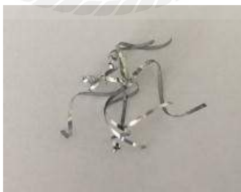
รูปที่ 4.17 ลักษณะเศษชิปจากการทดลองตัดผิวงาน
