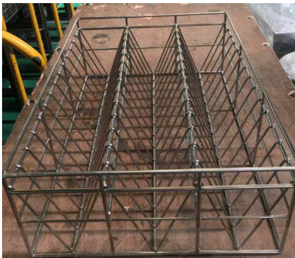
รูปที่ 4.13 ตะกร้าเหล็กหลังทำการแก้ไข
