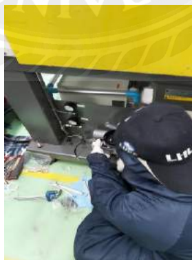
รูปที่ 4.3 ถอดอุปกรณ์ระบบน้ำมันอัตโนมัติ
