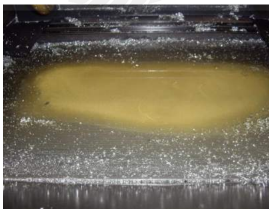
รูปที่ 3.8 ละอองน้ำมันหล่อลื่นไปผสมกับน้ำยาหล่อเย็น
