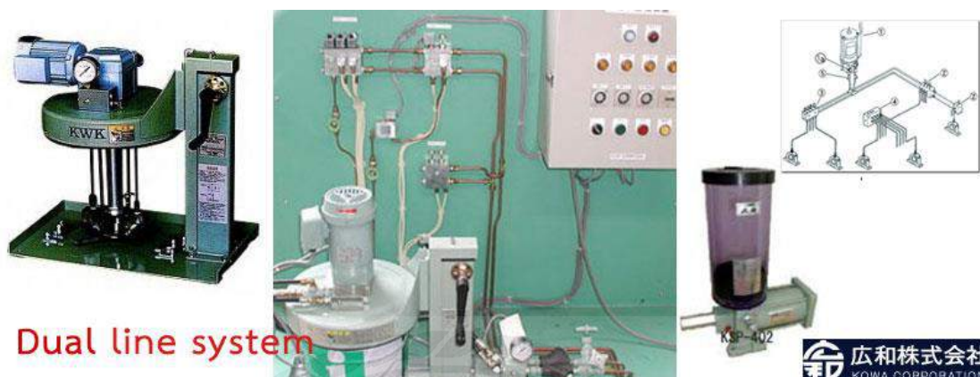
รูปที่ 2.30 ระบบหล่อลื่นแบบท่อคู่ Dual line system
