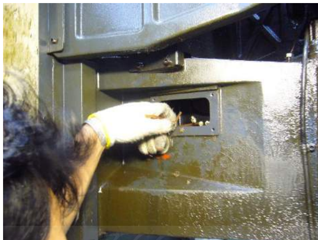
รูปที่ 3.7 เกิดละอองน้ำมันติดที่บริเวณเครื่องกัด CNC
