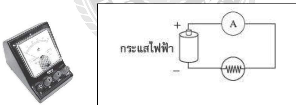
2.15 รูปแสดงลักษณะแอมมิเตอร์และการต่อแอมมิเตอร์ในวงจรไฟฟ้า
