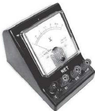
2.14 รูปแสดงลักษณะโวลต์มิเตอร์และการต่อโวลต์มิเตอร์ในวงจรไฟฟ้า
