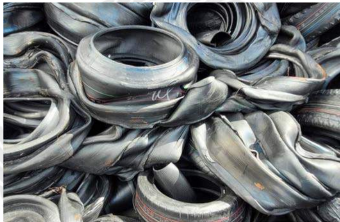
รูปที่ 4.33 ยางไม่ผ่านการตรวจสอบคุณภาพจากการผลิต
