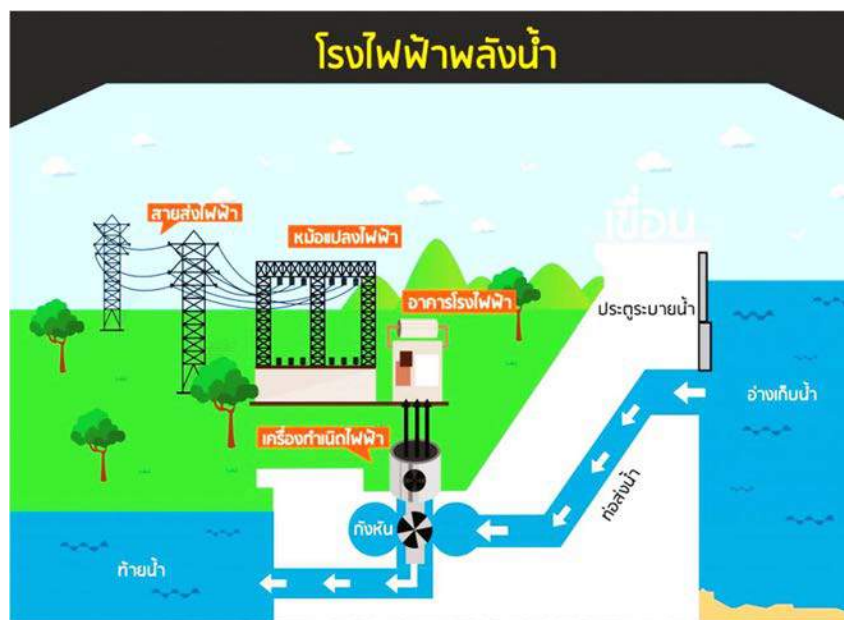
รูปที่ 2.2 การผลิตไฟฟ้าจากพลังงานน้ำ
