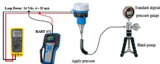
รูปที่ 3 : การต่ออุปกรณ์
