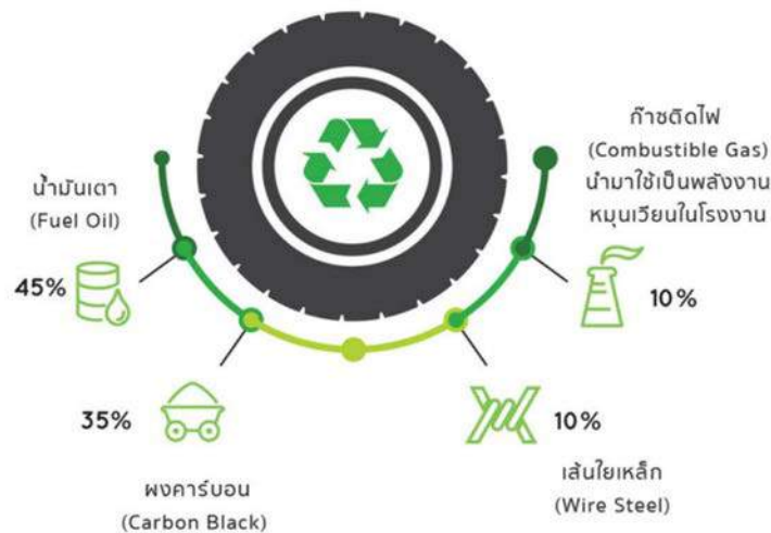
รูปที่ 2.11 ผลิตภัณฑ์ที่ได้จากกระบวนการไพโรไลซิสยางล้อเก่า
