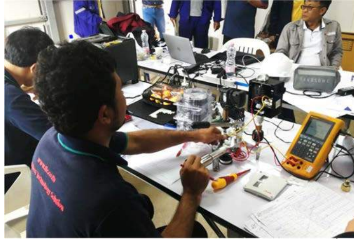
รูปที่ 4.17 การสอบเทียบอุปกรณ์ตรวจวัดก่อนการนำไปติดตั้ง
