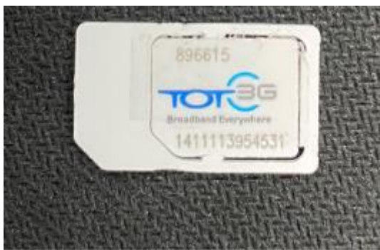
รูปที่ 2.7 SIM 3G ใช้งานบนคลื่นความถี่ 850/900/2100 MHz
