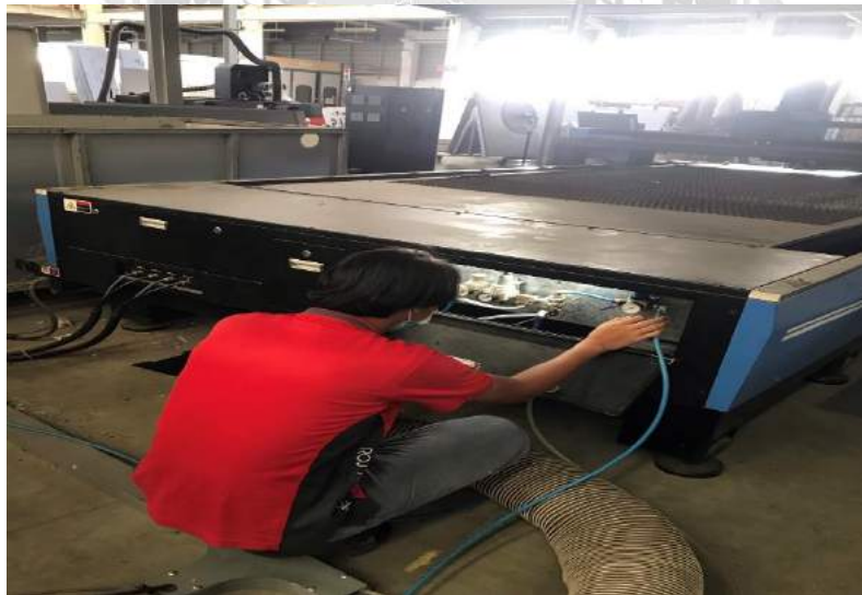
รูปที่ 4.1 แสดงการตรวจเช็คแรงดันลมของเครื่องตัดเลเซอร์
