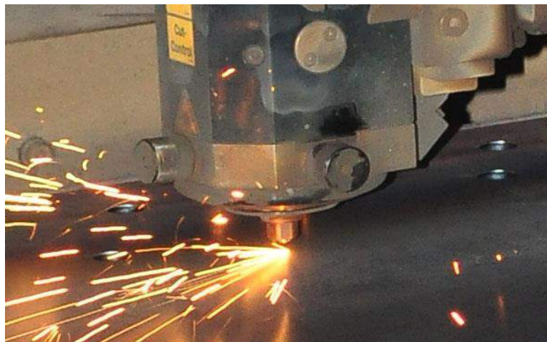
รูปที่ 3.4 แสดงหัวตัดเลเซอร์
