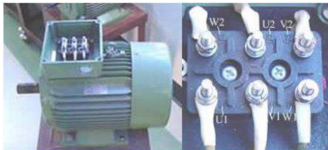
รูปที่ 2.20 การต่อจุดต่อสายของมอเตอร์สามเฟสแบบ Y (รูปซ้าย) และ Delta (รูปขวา)
