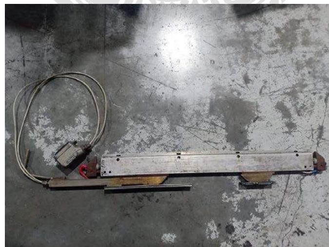
รูปที่ 4.10 เปลี่ยนเป็นสายไฟฟ้ากันความร้อน
