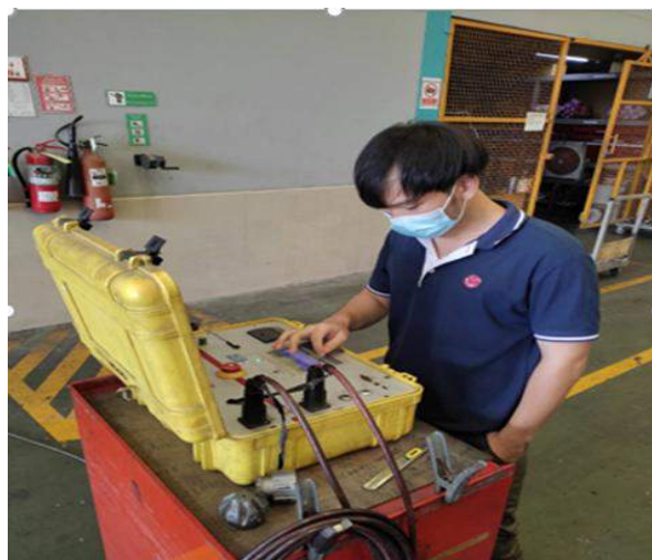
รูปที่ 4.11 ทำการ calibrate เครื่องทดสอบ Ratio ก่อนทำการใช้งาน
