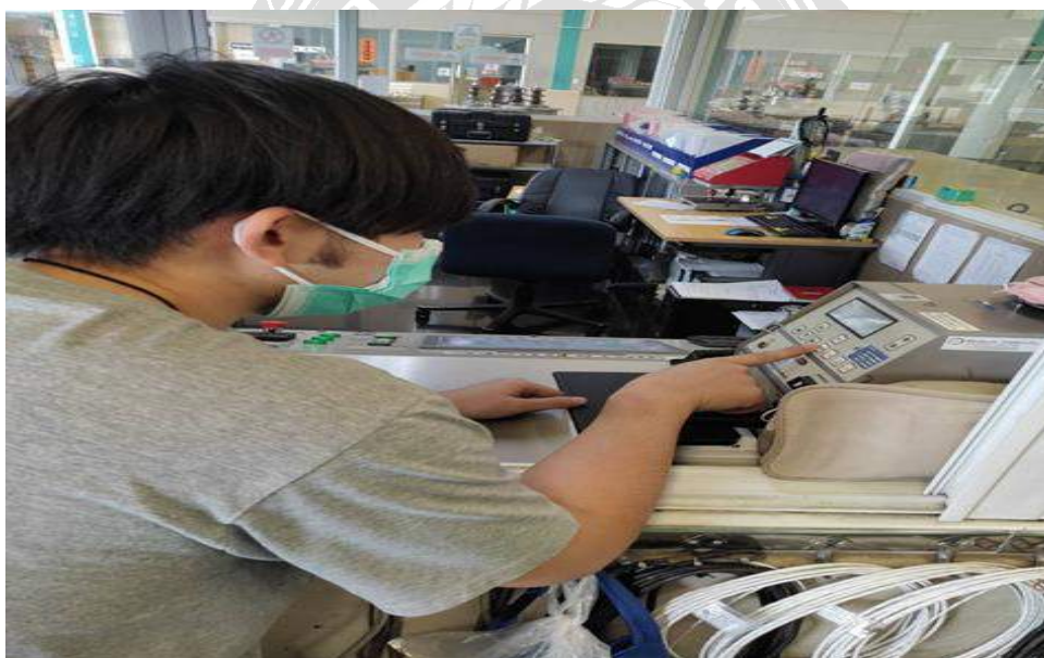
รูปที่ 4 การทดสอบหัวข้อ การวัดค่าความต้านทานของขดลวด
