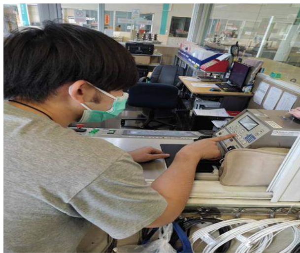
รูปที่ 4.36 ทำการ calibrate เครื่องทดสอบ DV POWER ก่อนใช้งาน
