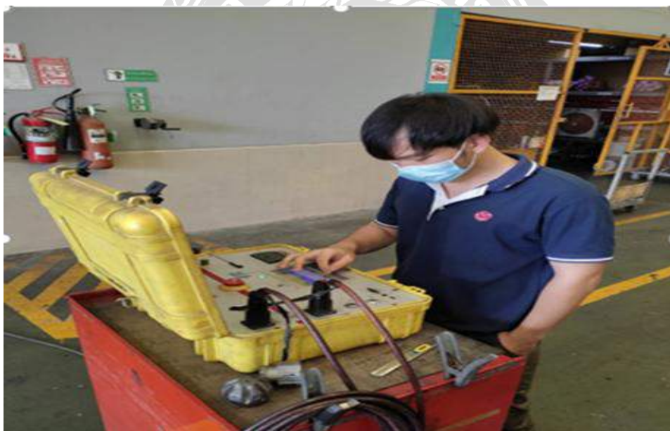
รูปที่ 2 การวัดค่าอัตราส่วนแรงดันและตรวจสอบสัญลักษณ์เฟสหรือเวกเตอร์รูป
