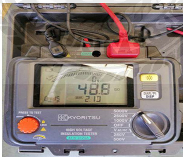
รูปที่ 4.4 ตรวจสอบ Range ก่อนเริ่มการทดสอบ
