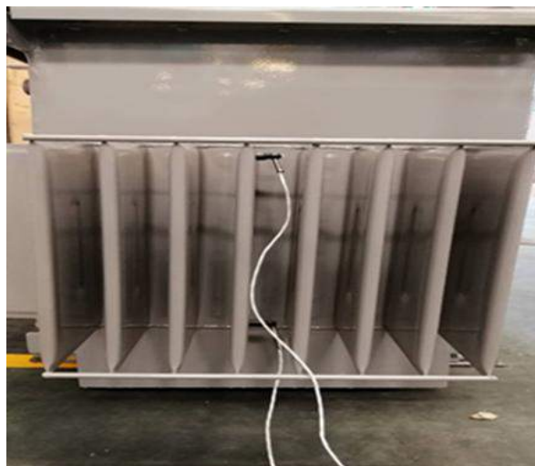
รูปที่ 4.41 วัตถุณหภูมิ PT.100 จำนวน 2 จุดเพื่อทดสอบ load loss
