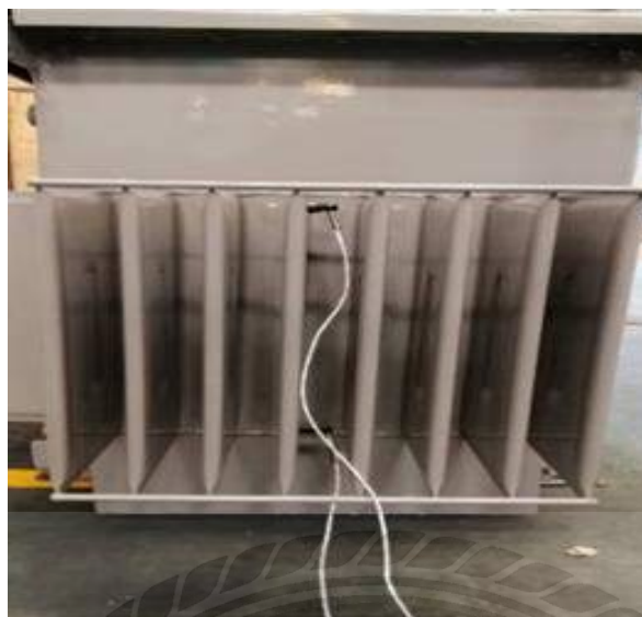
รูปที่ 4.38 วัดอุณหภูมิ PT.100 จำนวน 2 จุดเพื่อทดสอบ Resistance
