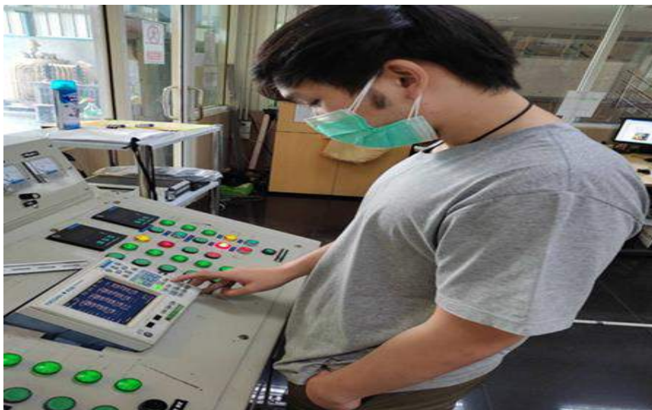
รูปที่ 3 การทดสอบหัวข้อ การวัดค่าความสูญเสียขณะไม่มีโหลด
