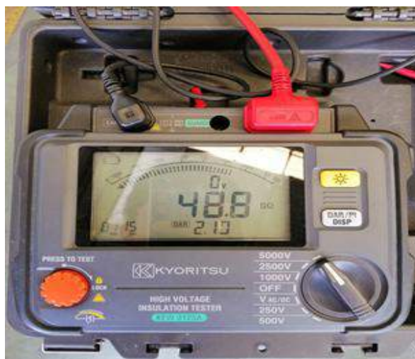
รูปที่ 4.6 วัดความเป็นฉนวนวงจร (Primary กับ Secondary)
