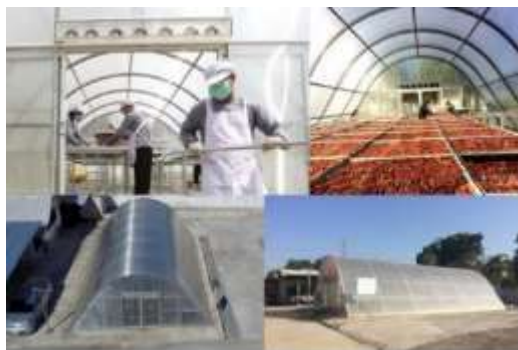
รูปที่ 2.3 พาราโบลาโดม ระบบอบแห้งพลังงานแสงอาทิตย์
