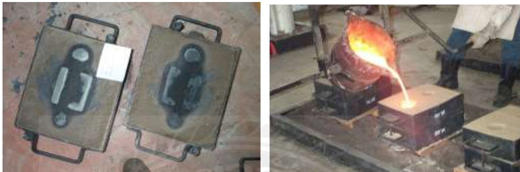
รูปที่ 2.40 รูปร่างของแบบหล่อที่เสร็จแล้ว รอการนำไปเทหล่อ
