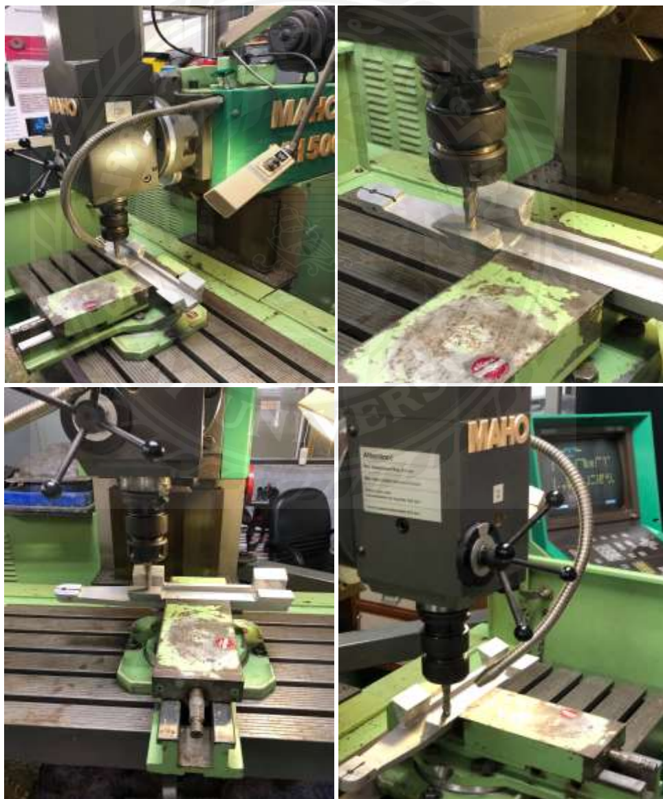
รูปที่ 3.18 การใช้เครื่องจักร CNC เพื่อกัดชิ้นงานให้ได้ระดับ
