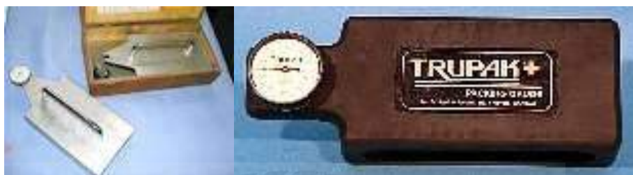
รูปที่ 3.5 เครื่องมือวัดรองหนุน (Packing Gauge) ทั้งสองประเภท (ที่มา : presspart.co.uk and amazon.com.2554 )
