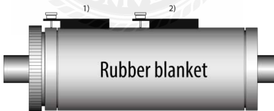
รูปที่ 3.4 การวัดความสูงของผ้ายางโดยใช้เครื่องมือวัดการรองหนุน (Packing gauge)
