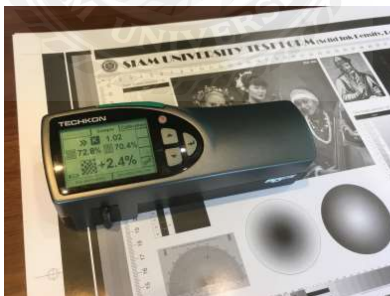
รูปที่ 3.22 การวัดแถบควบคุมการลองหนุ่นด้วยเครื่อง Spectrophotometer
