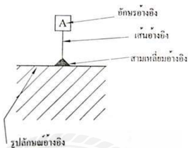
รูปที่ 2.19 แสดงอักษรอ้างอิง เส้นอ้างอิง และสามเหลี่ยมอ้างอิง (ที่มา : มอก.-210,2529 : เล่ม 6)
