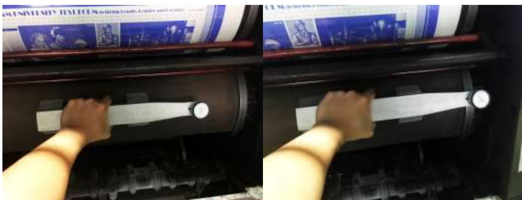
รูปที่ 3.25 แสดงการวัดระยะลึกป่าโมแม่พิมพ์ด้วยเครื่องมือวัดรองหนุนมาตรฐาน
