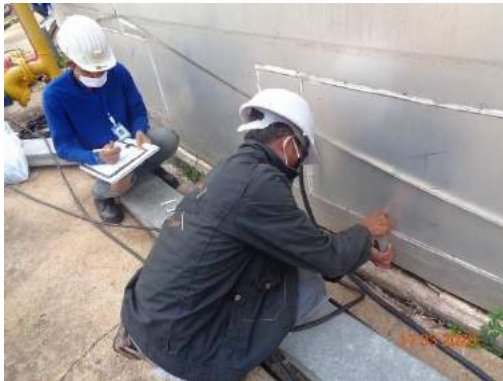
ภาพที่ 4 การตรวจสอบด้วย Rebound Hammer ตามมาตรฐาน ASTM C 805 [1]
