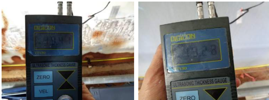
ภาพที่ 7 ตรวจสอบความหนาเหล็กโดย Ultrasonic Thickness
