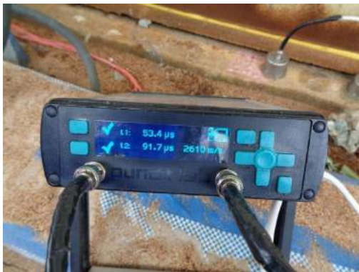
ภาพที่ 5 การตรวจสอบด้วย Ultrasonic Pulse Velocity ตามมาตรฐาน ASTM C 597 [2]
