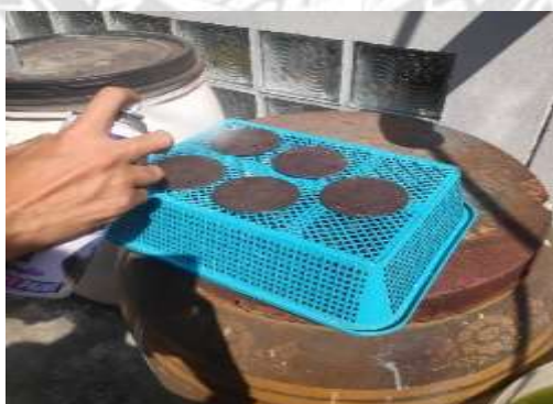
รูปที่ 4.17 พ่นแล็กเกอร์เคลือบที่รองแก้ว
