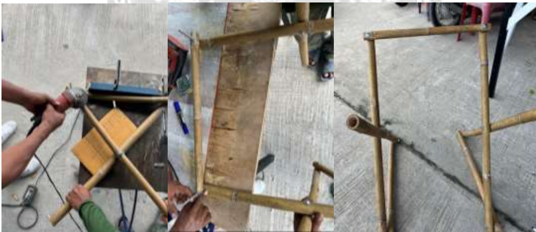
รูปที่ 4.6 ตัดน็อตที่ยาวเกินออกด้วยเครื่องเจียรไฟฟ้า ที่มา : คณะผู้จัดทำ (2564)
