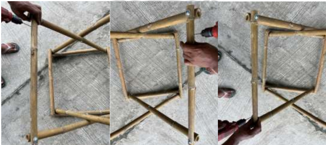
รูปที่ 4.9 เจาะรูไม้เพิ่มเติม
