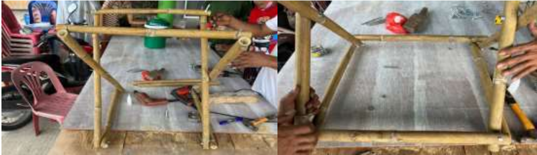
รูปที่ 4.7 นำไม้มาประกบประกอบเข้ากัน ใช้น็อตยึดไว้
