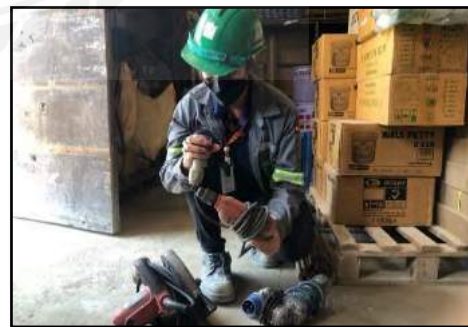
รูปที่ 2.25 ตรวจสอบการชำรุดของอุปกรณ์ไฟฟ้า
