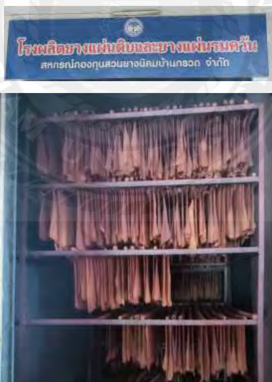
รูปที่ 5.14 ยางเครปบางจากการรีดนำมาอบแห้งตามขบวนการผลิตยางเครปบางมาตรฐาน GMP เพื่อนำไปผลิตเป็นยางอัดแท่ง
