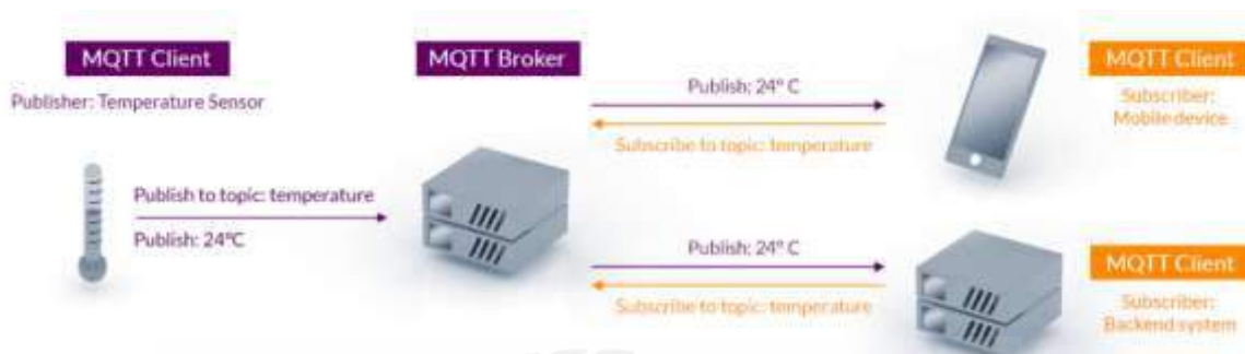
รูปที่ 2.7 สถาปัตยกรรมของ Message Queuing Telemetry Transport (MQTT)
