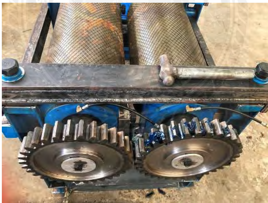
รูปที่ 3.17 ประกอบเฟืองขับและเฟืองตาม
