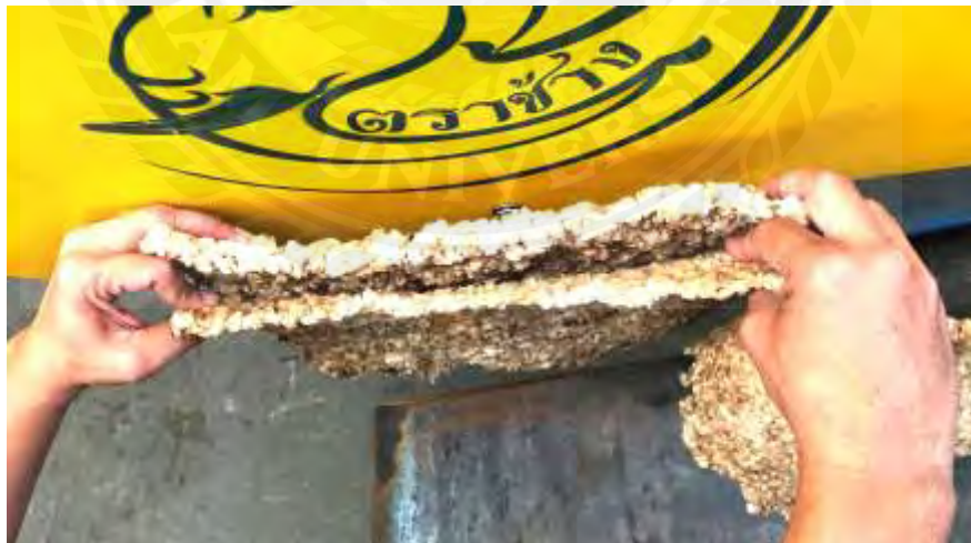
รูปที่ 4.7 เปรียบเทียบความหนาของแผ่นยางเครปที่ได้จากการรีดด้วยเครื่องรีดยางทั่วไป (แผ่นบน) เทียบกับ ยางเครปที่ได้จากเครื่องรีดยางเครปบาง (แผ่นล่าง)
