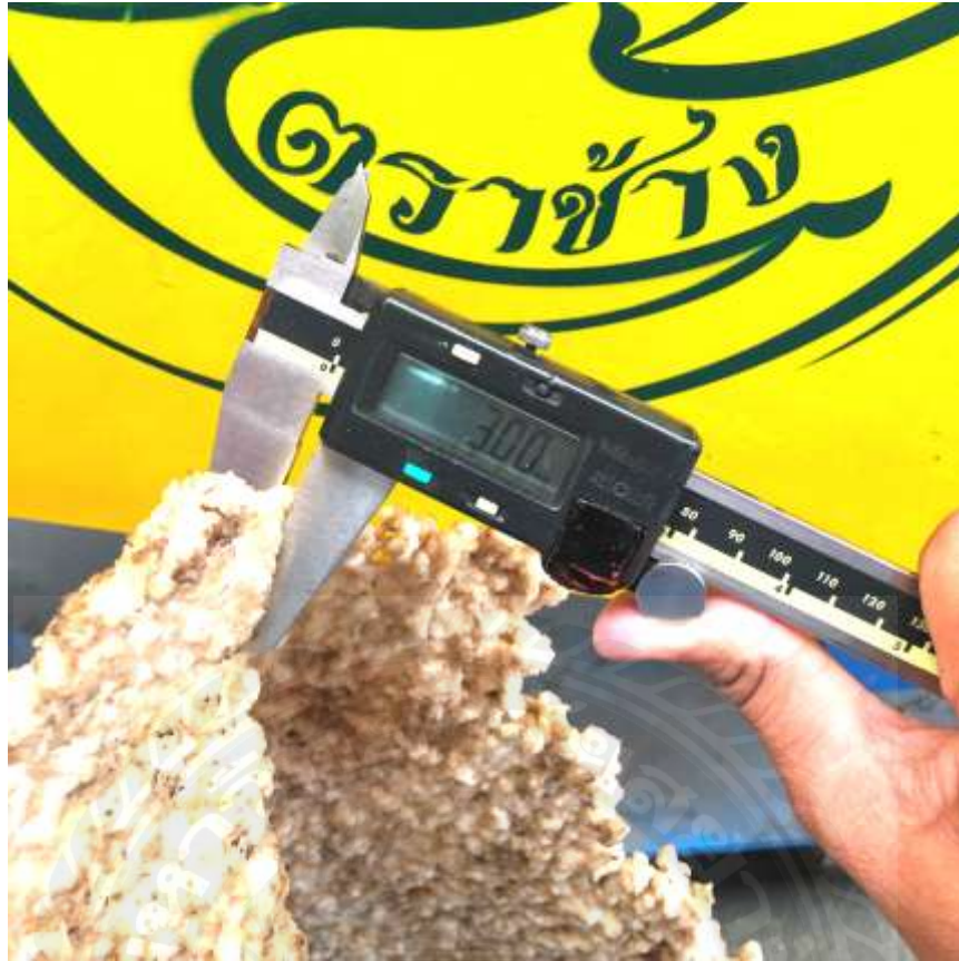
รูปที่ 4.6 ยางเครปที่ผ่านกระบวนการรีดด้วยเครื่องรีดยางเครปบางจำนวน 3 รอบ ได้ความหนาแผ่นยางเฉลี่ย 3.00 มิลลิเมตร
