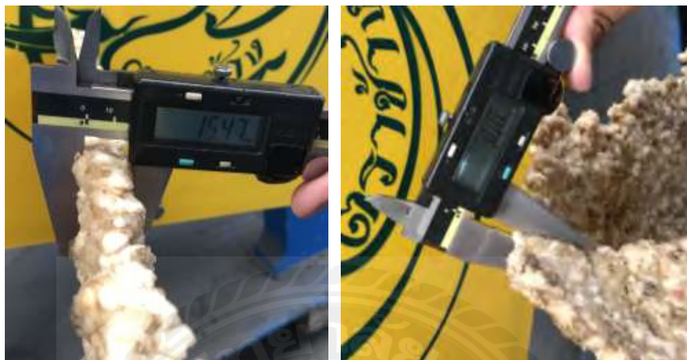
รูปที่ 3.29 เปรียบเทียบความแตกต่างความหนาของการรีดด้วยเครื่องเครปหยาบกับเครื่องเครปบาง
