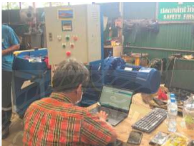
รูปที่ 4.8 ต้นแบบเทคโนโลยีเครื่องจักรรีดยางเครปบางที่ประกอบชุดเก็บข้อมูลทางไกลผ่านสัญญาณโทรศัพท์ บันทึกบน Cloud Computing
