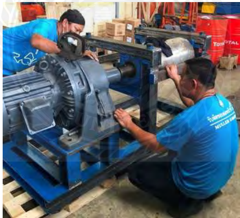
รูปที่ 3.15 มอเตอร์เกียร์ต้นกำลังประกอบเข้ากับลูกรีด
