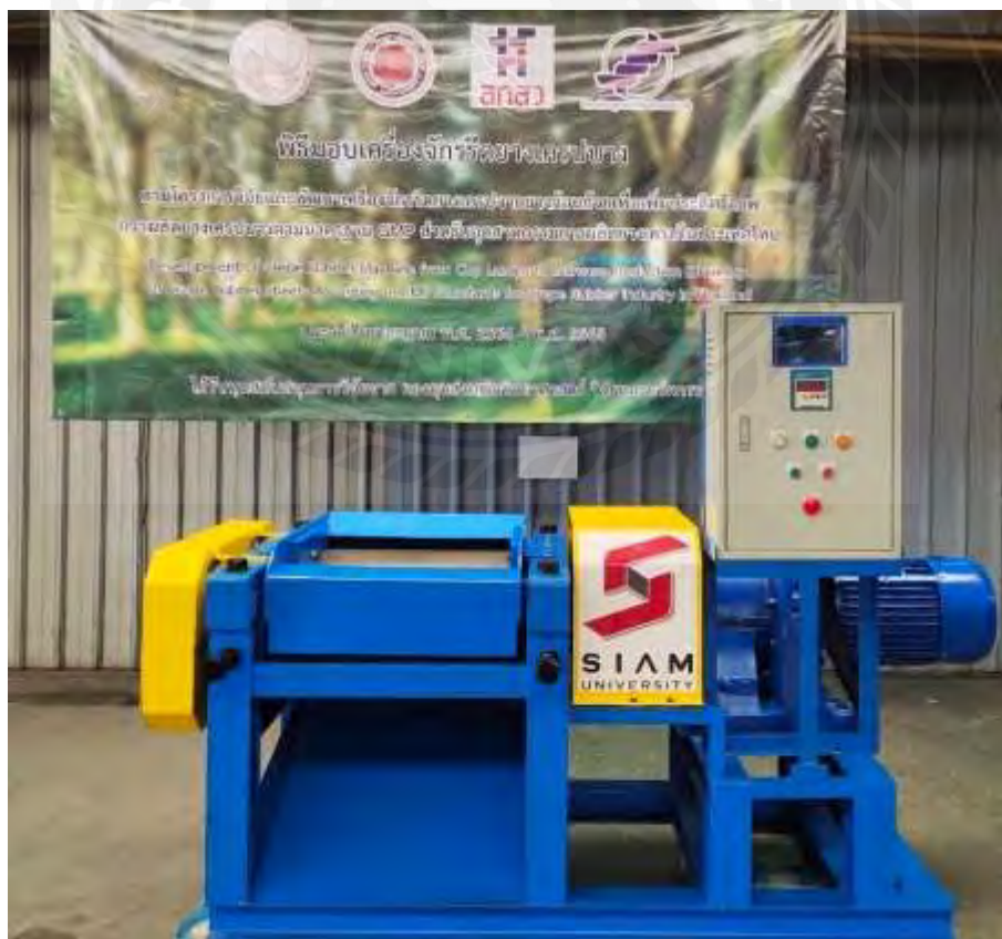
รูปที่ 3.26 เครื่องจักรรีดยางเครปบางที่ออกแบบและสร้างเสร็จสมบูรณ์
