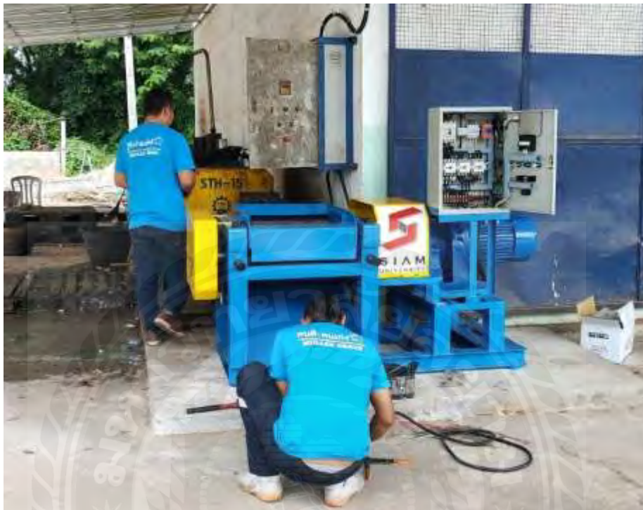
รูปที่ 3.27 ติดตั้งเครื่องจักรรีดยางเครปบาง ที่สหกรณ์กองทุนสวนยางบ้านกรวด
