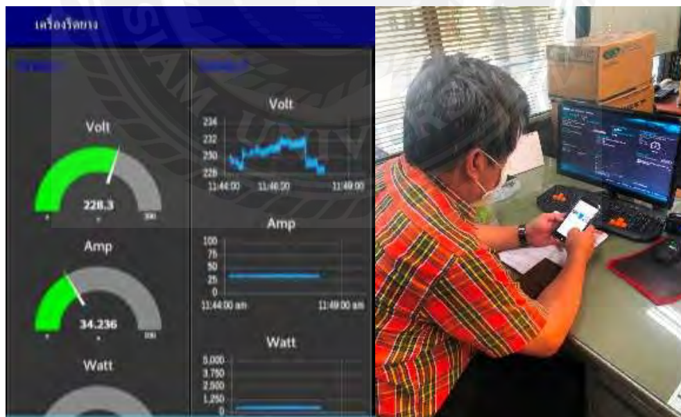
รูปที่ 3.33 เก็บข้อมูลการใช้พลังงานของเครื่องรีดยางผ่านทาง web browser ภายนอกสถานที่ผ่านสัญญาณ โทรศัพท์บนที่กบน Cloud computing
