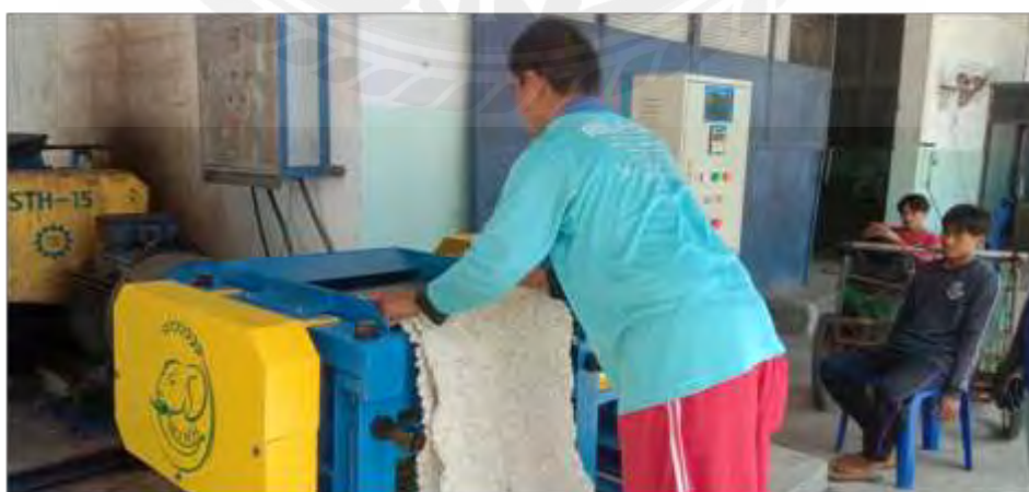
รูปที่ 3.28 นำยางเครปหนามาทดสอบรีดเครื่องจักรรีดยางเครปบาง
