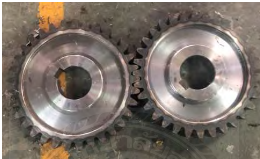
รูปที่ 3.16 เฟืองขับและเฟืองตาม
