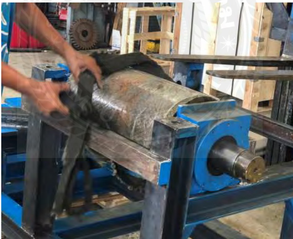
รูปที่ 3.13 ประกอบลูกรียางเครปบางเข้ากับโครงเครื่อง
