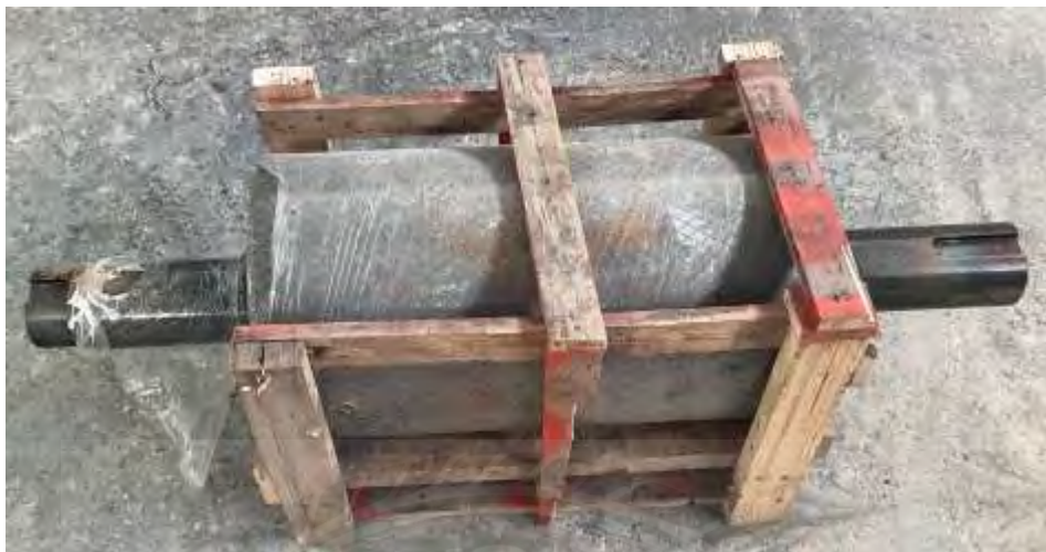
รูปที่ 3.12. ลูกรียางเครปบางเหล็กหล่อ FCD-440 ขนาดเส้นผ่านศูนย์กลาง 305 มิลลิเมตร
