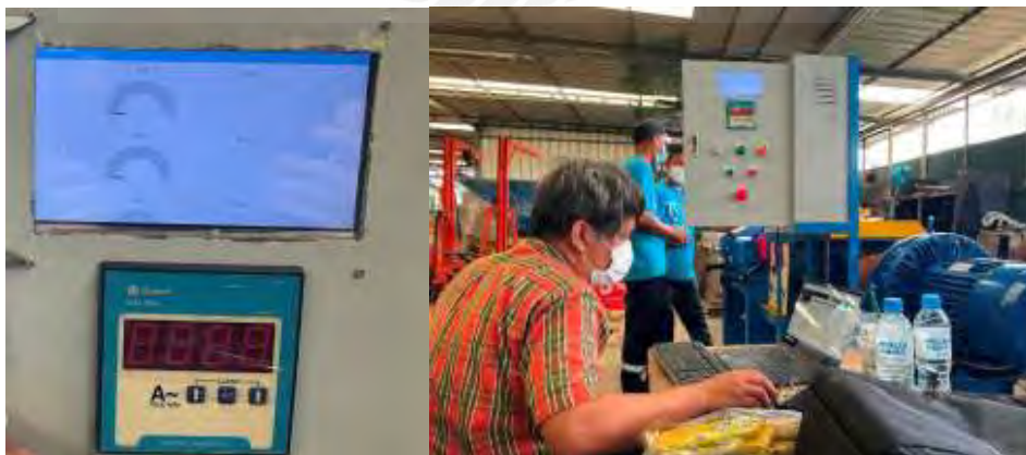
รูปที่ 3.31 ผู้ใช้งานสามารถติดตามการใช้พลังงานของเครื่องรีดยางเครปบางได้บนหน้าจอของเครื่อง
