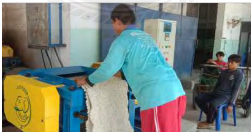
รูปที่ 4.5 ยางเครปน้ำหนัก 30 กิโลกรัมต่อแผ่นเข้ากระบวนการรีดด้วยเครื่องรีดยางบาง
