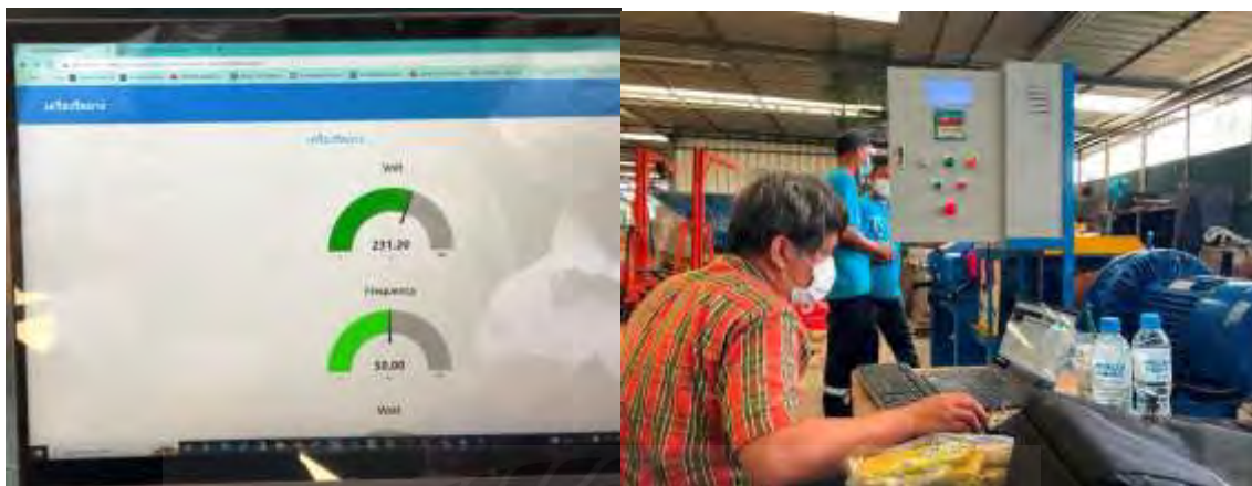
รูปที่ 3.25 ทดสอบชุดเก็บข้อมูลทางไกลผ่านสัญญาณโทรศัพท์บันทึกบน Cloud computing
