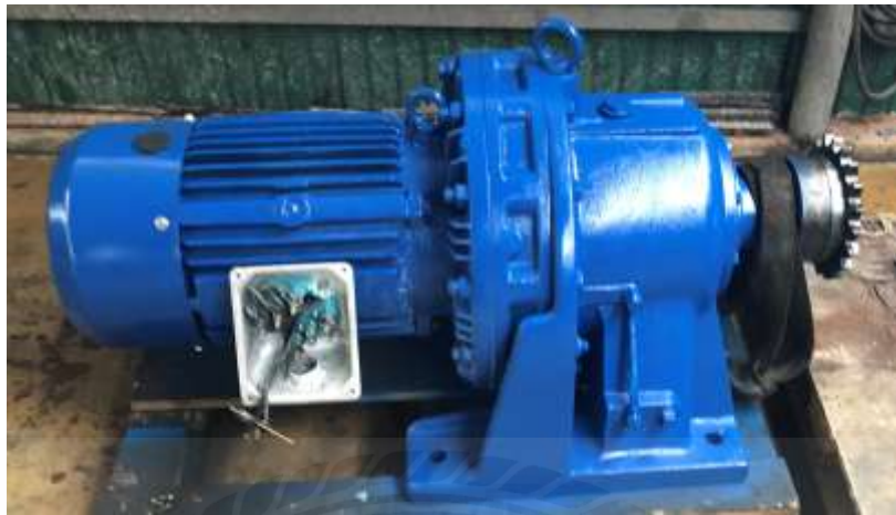
รูปที่ 3.14 มอเตอร์เกียร์ Cycloidai Gear Head Model CLB8X 15 แรงม้า (11KW)
