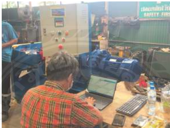
รูปที่ 3.30 ต้นแบบเทคโนโลยีเครื่องจักรรีดยางเครปบางที่ประกอบชุดเก็บข้อมูลทางไกลผ่านสัญญาณโทรศัพท์บันทึกบน Cloud computing
