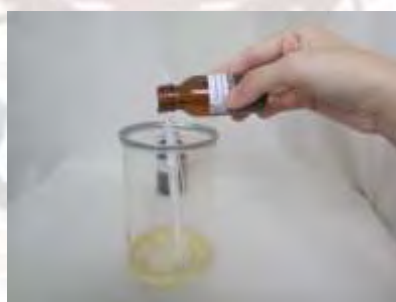
รูปที่ 4.12 เดิมไดโพรไพลีน ไกลคอล ลงไปและคนให้เข้ากัน ที่มา : ผู้จัดทำ
