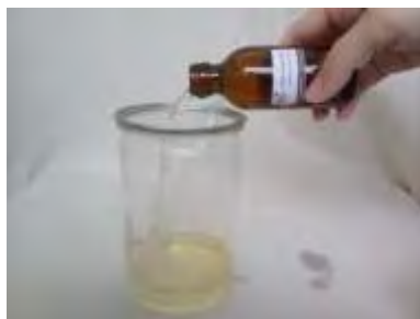
รูปที่ 4.13 เติมนีเอทิล แอลกอฮอล์ 95% และคนให้เข้ากัน ที่มา : ผู้จัดทำ
