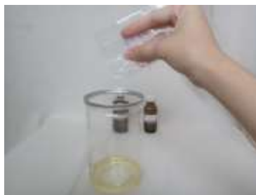
รูปที่ 4.10 แกะทวิน20 ตัดปลายถุง เทลงไปในน้ำมันหอมระเหย ที่มา : ผู้จัดทำ
