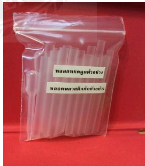
หลอดพลาสติกใช้ตักตัวอย่างยาใส่หลอดทดสอบ
