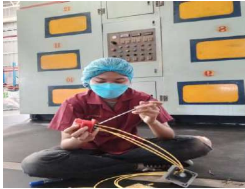
รูปที่ 4.18 การติดตั้งโซลีนอยด์
