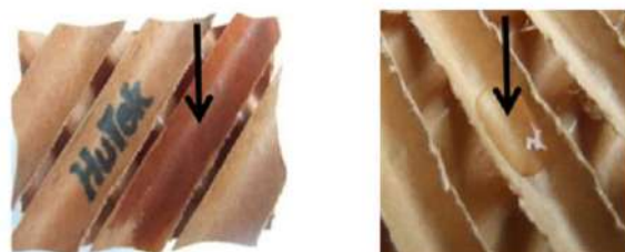
รูปที่ 2.6 เปรียบเทียบประสิทธิภาพการดูดซับน้ำของกระดาษ
