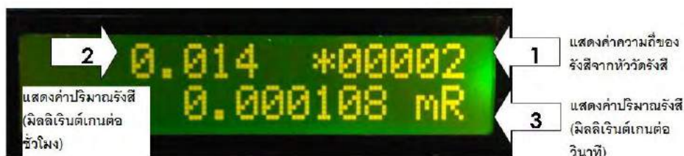
รูปที่ 9 หน้าจอแสดงผลลิกเหลว แสดงผลปริมาณรังสีที่วัดได้
