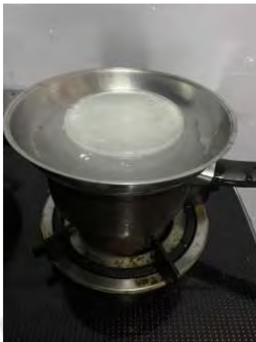
รูปที่ 4.12 นำน้ำแข็งมาวางไว้บนฝา
