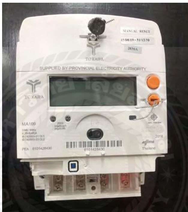
รูปที่ 2.12 มิเตอร์ 1 เฟส 2 สาย แบบต่อตรง ทีโอยู
