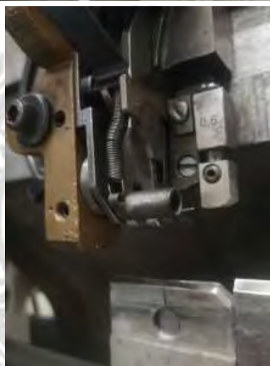
รูปที่ 4.44 ซ่อมหัวเย็บสันหนังสือ
