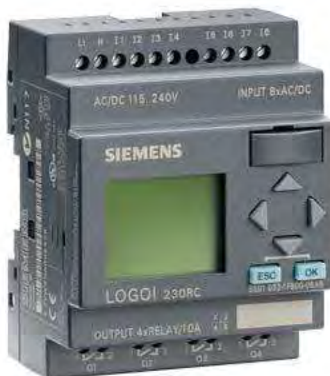
รูปที่ 2.9 ลักษณะของ PLC รุ่น LOGO! 230RC ที่ใช้ในชุดทดลอง
