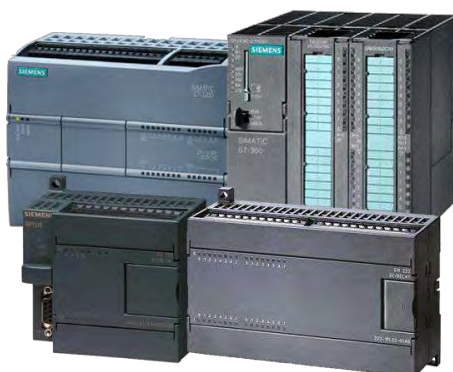
รูปที่ 2.8 PLC SIEMENS
