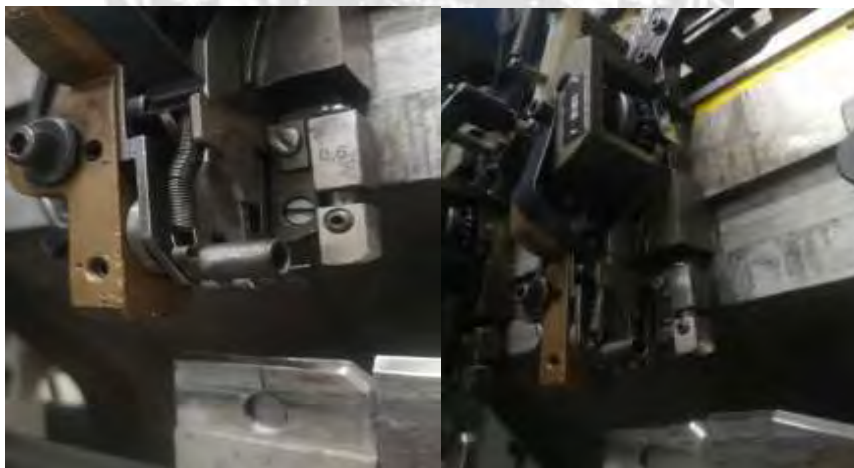
รูปที่ 4.46 รูปแสดงสภาพหลังเปลี่ยนสปริงแล้ว
