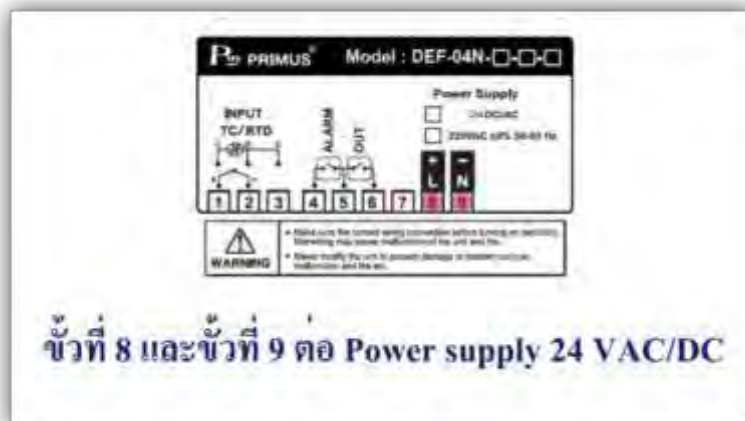
รูปที่ 4.14 การต่อ Power Supply ให้กับผลิตภัณฑ์
