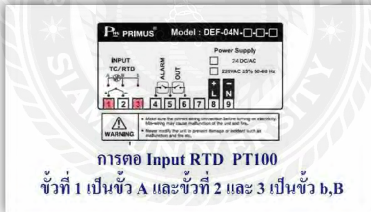
รูปที่ 4.16 การต่อ Input RTD PT 100
