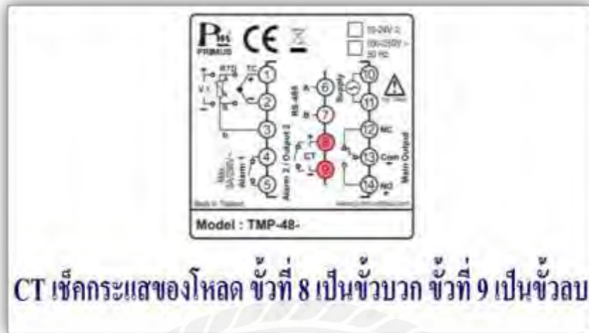
รูปที่ 4.53 การต่อ CT เซ็ทกระแสของโหลด
