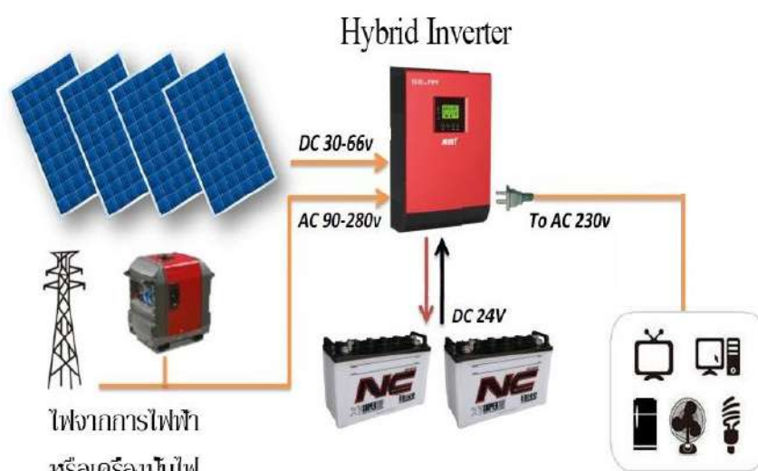
รูปที่ 2.6 ภาพจำลองการต่อใช้งานระบบไฮบริดส์
