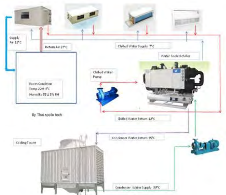
รูปที่ 2.16 ประเภททำน้ำเย็นระบายความร้อนด้วยน้ำ (Air Cooler Water Chiller)
