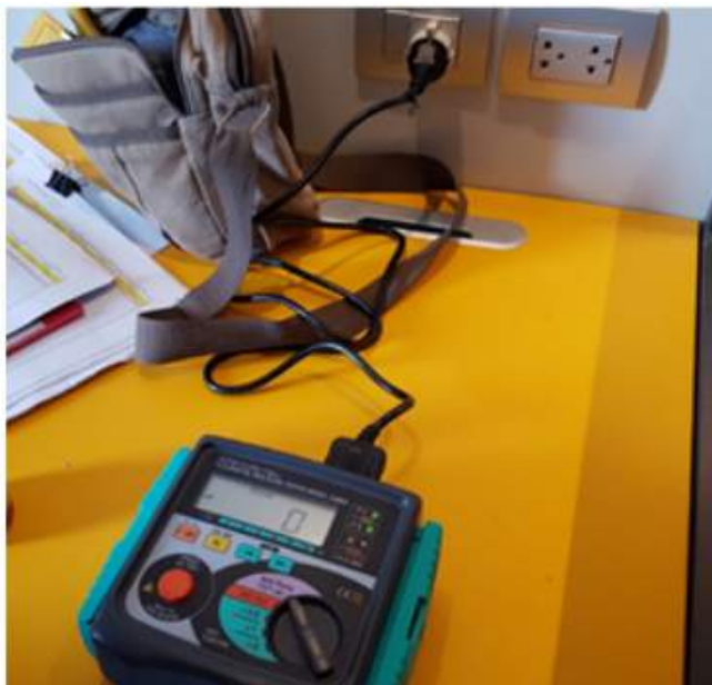
รูปที่ 4.18 เครื่องตรวจสอบเบรกเกอร์ตัว ไฟรั่วไหล (ELCB Tester)
