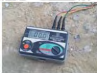
รูปที่ 4.27 อุปกรณ์การวัดความต้านทานดิน Earth Tester Meter
