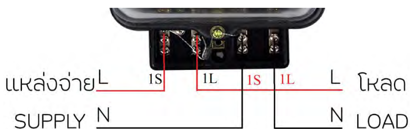
รูปที่ 2.4 การเข้าสายมิเตอร์ 1 เฟส ของยี่ห้อ Mitsubishi
